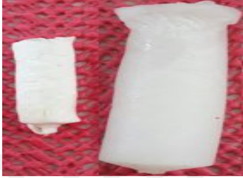
Şekil 4.1: Kurutulmuş ve şişmiş Cu 2+ -O-CMCS-4a kompozit kriyojel.
