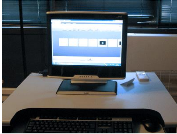
Resim 11. ODTÜ İnsan Bilgisayar Etkileşim Laboratuvarı Tobii T120 göz izleme cihazı
