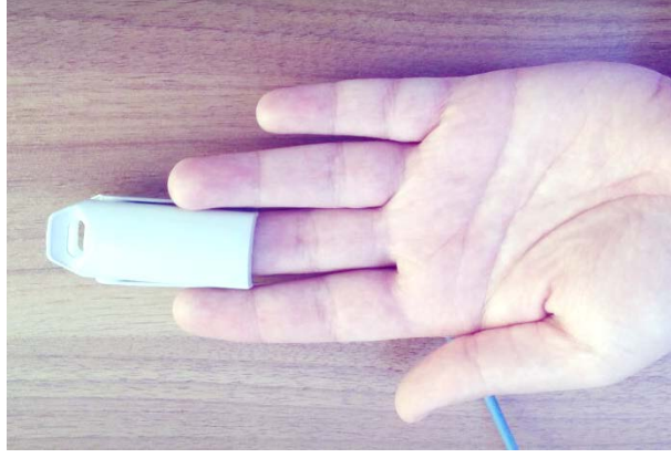
Resim 3. Kalp atım hızı verilerinin kayıtlanması sırasında kullanılan bir mandallı fotopletizmograf.
