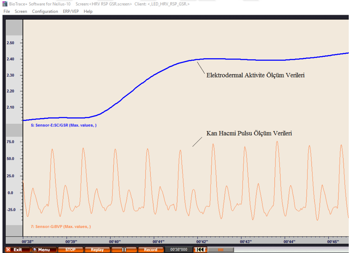
Şekil 23. Kalp atım hızı ve elektrodermal aktivite verilerinin kaydı ve analizi için kullanılan BioTrace+ yazılımı ile oluşturulmuş kayıt ekranı.
