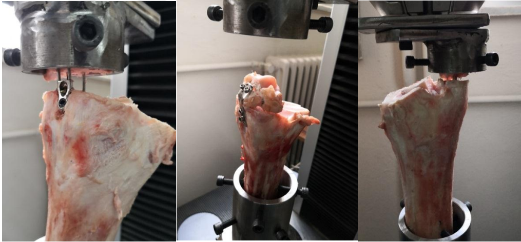
Şekil 35. Çekme kuvvetlerinde katastrofik hasar anları
