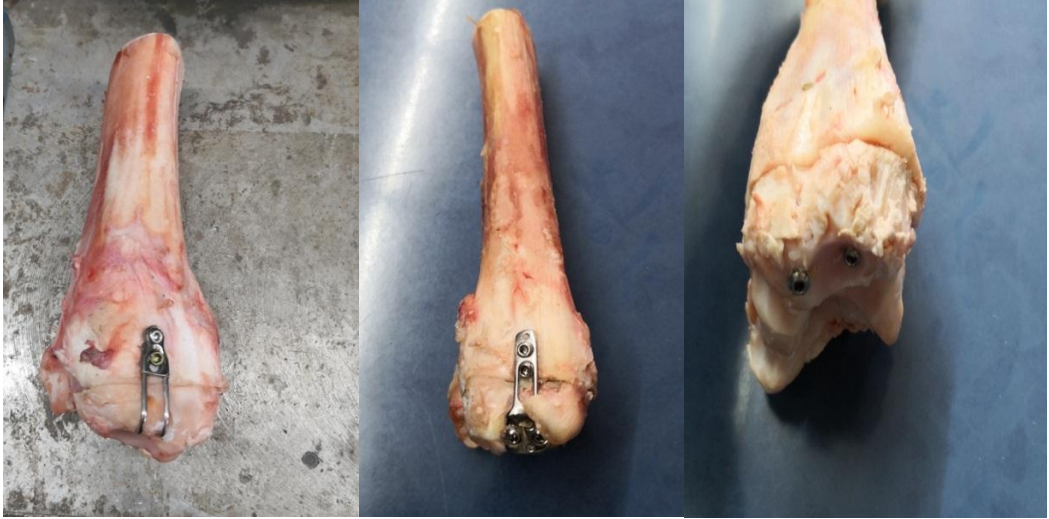
Şekil 29. Tespit edilmiş kırıklar (soldan sağa; hazır gergi bandı, malleol plağı, malleol vidası)
