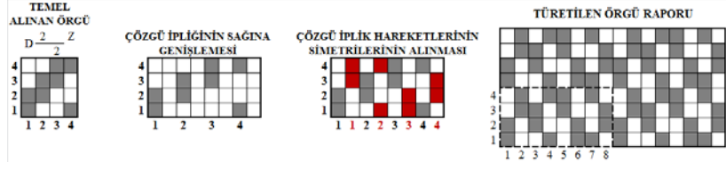
Şekil 26. Örgü raporunun çözgü sırasınca 1:1 oranında genişletilerek negatifinin kullanılmasıyla yeni bir örgü türetilmesi
