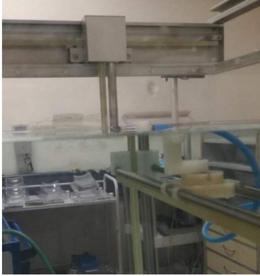
Resim 31. PTW 31010 iyon odası su yüzeyinde ve ölçüm noktasında ( d=10 cm).
