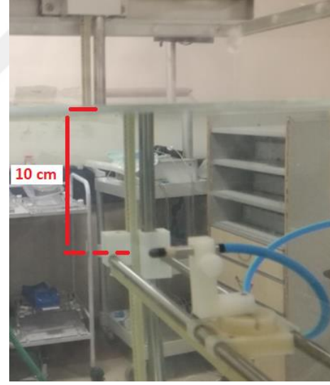
Resim 31. PTW 31010 iyon odası su yüzeyinde ve ölçüm noktasında ( d=10 cm).
