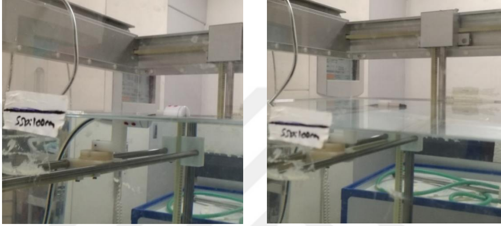
Resim 26. Iba CC13 iyon odasının su yüzeyinde başlıklı ve başlıksız görünümü.
