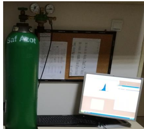
Resim 10. TLD okuyucu, bilgisayar ve azot t p nden oluŐan TLD okuma sistemi.
