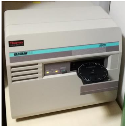
Resim 10. TLD okuyucu, bilgisayar ve azot t p nden oluŐan TLD okuma sistemi.
