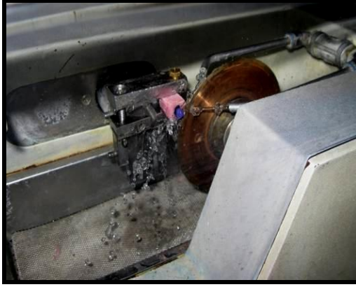
Resim 25: Örnekleri su soğutması altında mikrokot cihazında kesilmesi (Micracut, Metkon Instruments LTD., Bursa, Turkey).
