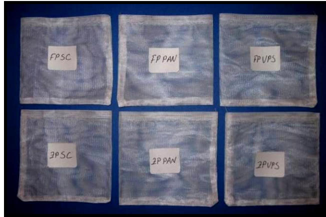
Resim 16: Örnekleri içerisinde yerleştirdiğimiz, su geçişine izin veren keseler.
