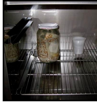
Resim 18: Etüv Cihazı (Nüve EN 120, Ankara, Türkiye) ve Örneklerin etüv cihazına yerleştirilmesi
