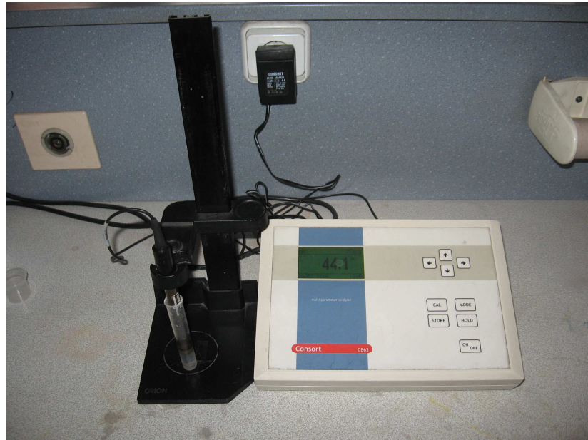
Resim 6: İyon analiz cihazına (pH/ISE meter, model 710A) bağlı iyon seçici elektrot (96-09BN)
