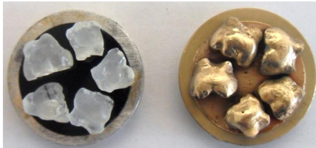
Resim 10 : Alüminyum taşıyıcıya yerleştirilen ve altın kaplanan replikalar
