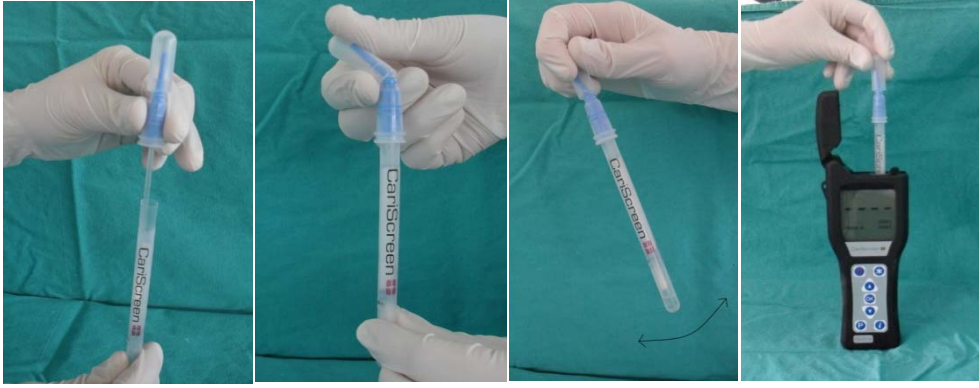
Resim5: Örneklerin CariScreen ATPmetre cihazı ile değerlendirme aşamaları
