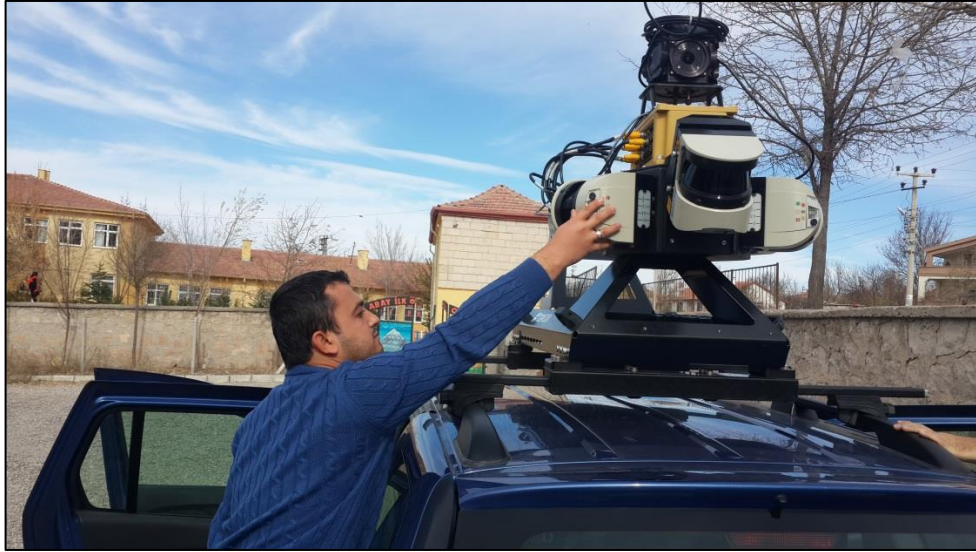
Şekil 2.16: Topcon IP-S2 yersel mobil lazer tarama sistemi.
