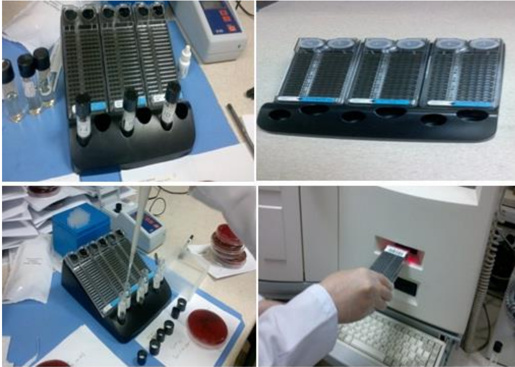
Şekil 8: Bakteri tanımlanmasında kullanılan Vitek-2 GP Sistemi
