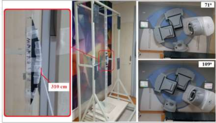
Şekil 242: 3 cm Abdomen fantomu için Klasik TSEI profil ölçüm kurulumu.
