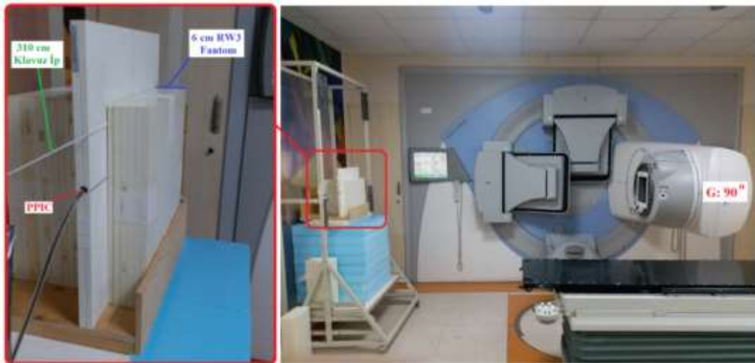
Şekil 152: X-ışını kontaminasyonu enerjisi belirleme ölçümü ışınlama kurulumu.
