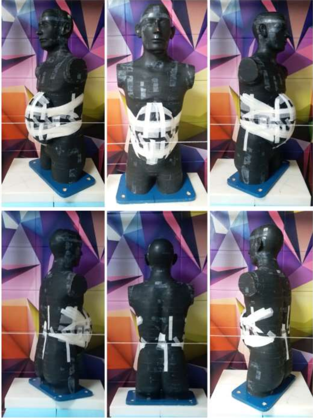
Şekil 248: TSEI fantom içi doz dağılımı ölçümü için ışınlama kurulumu.
