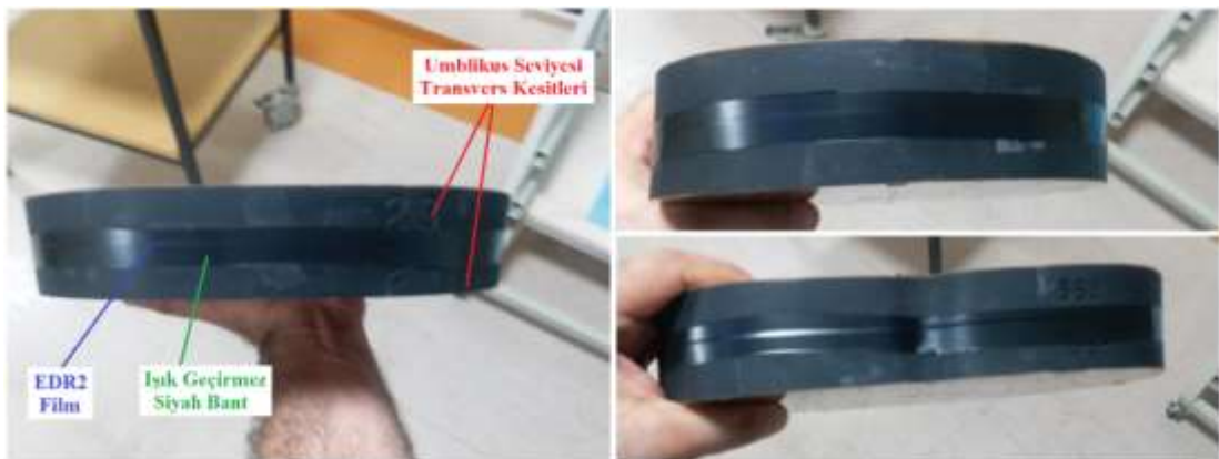
Şekil 141: Umbilikus seviyesinde insan fantomu içine EDR2 filminin yerleştirilmesi.
