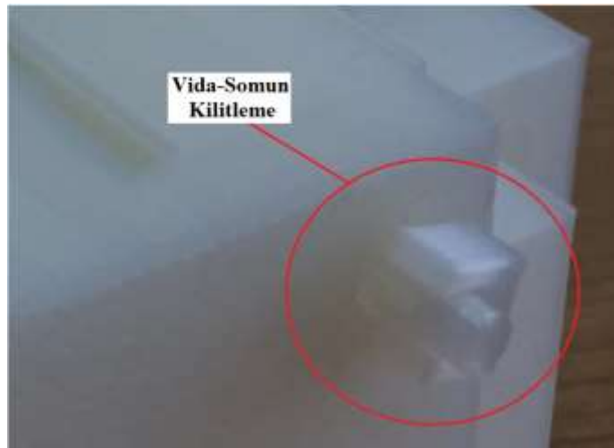
Şekil 205: Profil çubuğu bağlantı fantomu vida ve somunlarının kullanımı.
