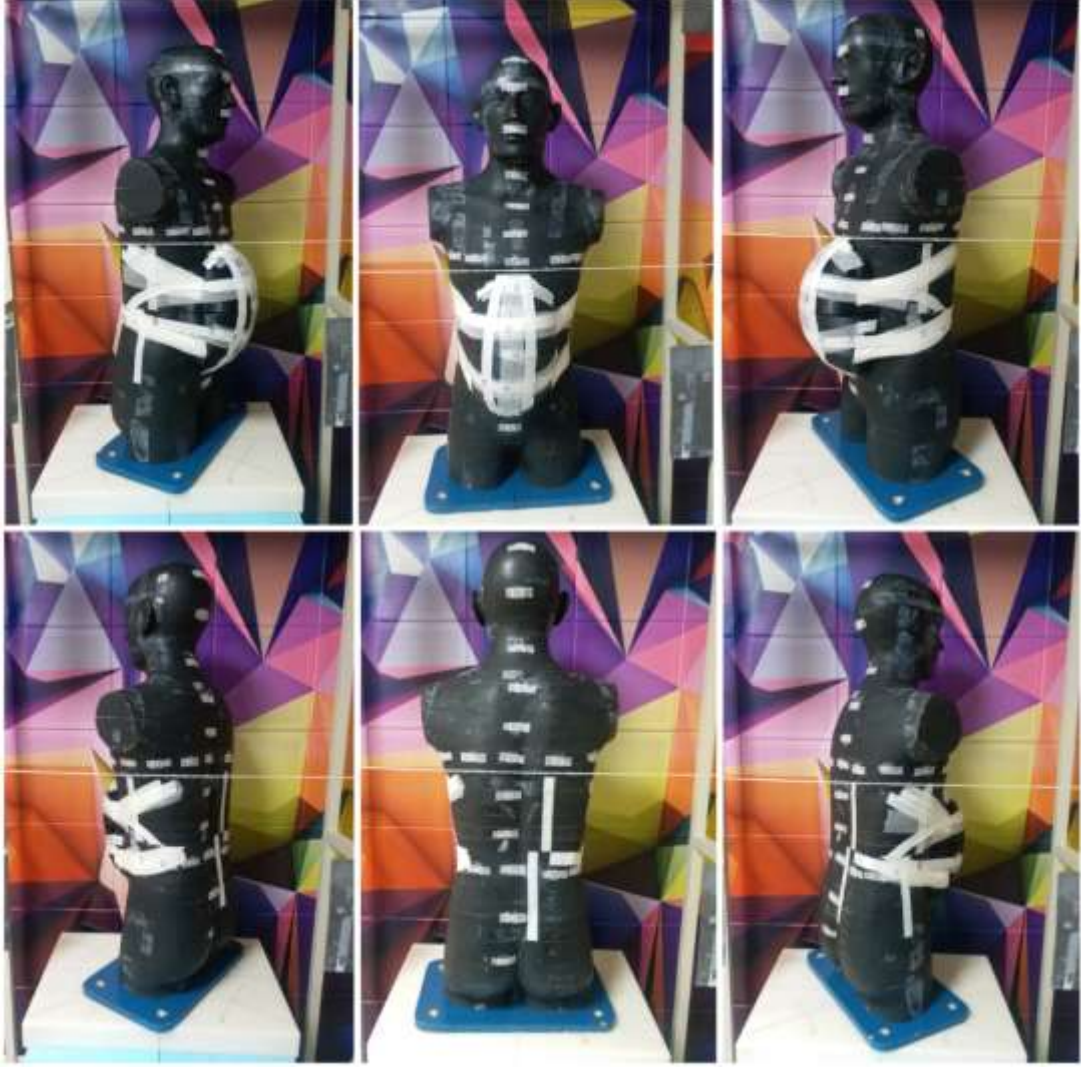
Şekil 220: 9 cm abdomen kalınlığı için bileşik doz ölçümü.
