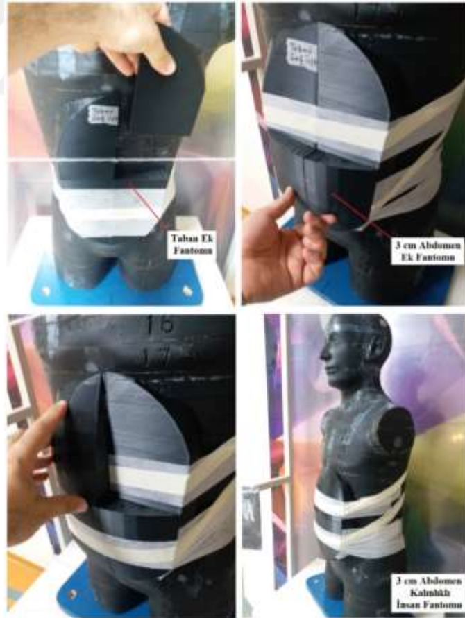
Şekil 215: 3 cm abdomen kalınlığına sahip insan fantomunun oluşturulması.
