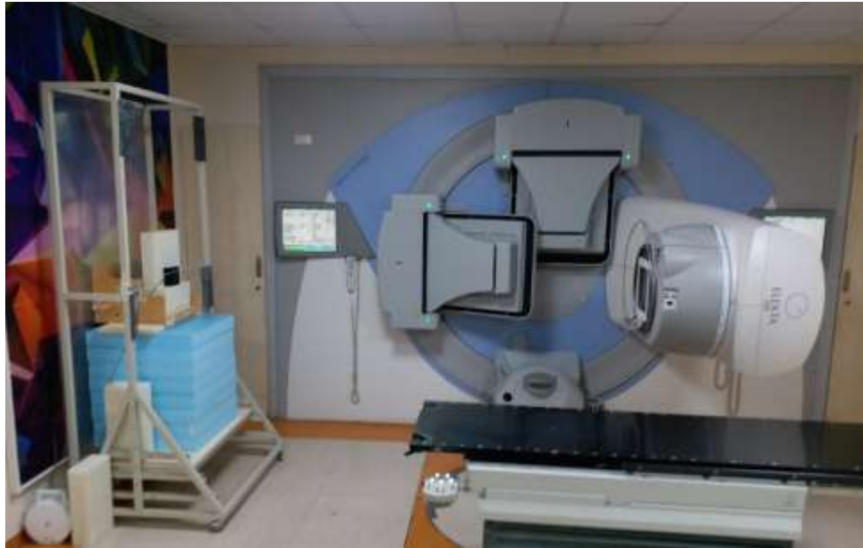
Şekil 84: Siyah ABS fantomunda gantri 90° de bir derinlik için doz ölçümü.
