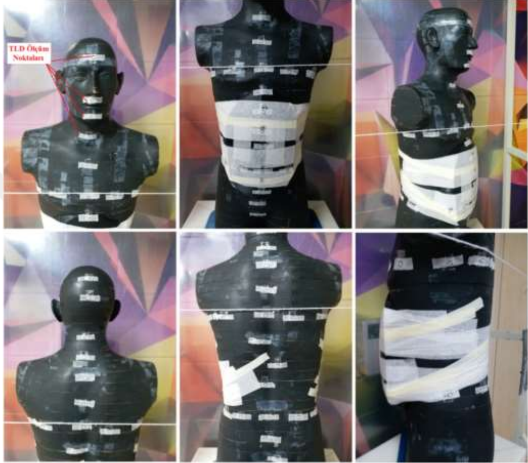
Şekil 216: 3 cm abdomen kalınlığına sahip insan fantomu için TLD ölçüm noktaları.
