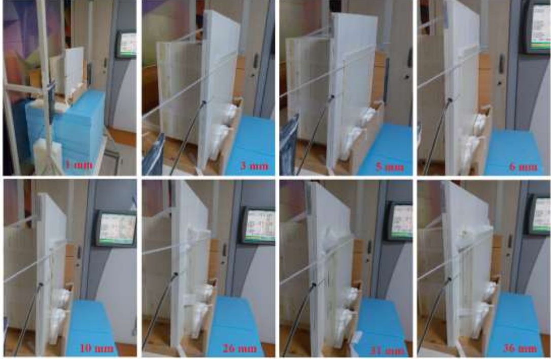
Şekil 88: RW3 katı fantomunda gantri 90°'de farklı derinlikler için doz ölçümü.
