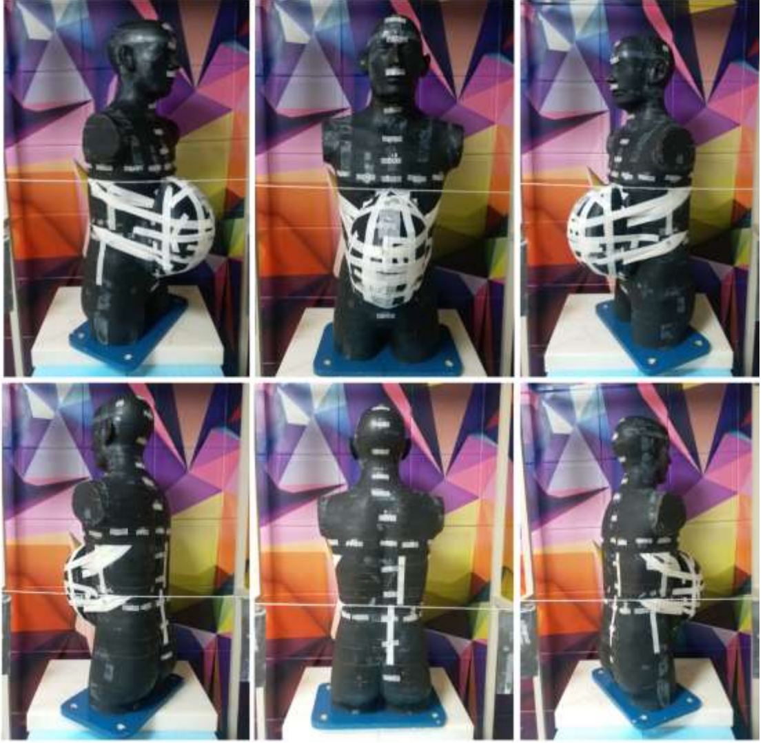
Şekil 222: 15 cm abdomen kalınlığı için bileşik doz ölçümü.
