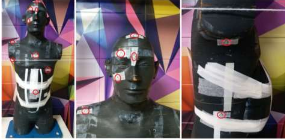
Şekil 254: İnsan fantomu TLD ölçüm noktaları.
