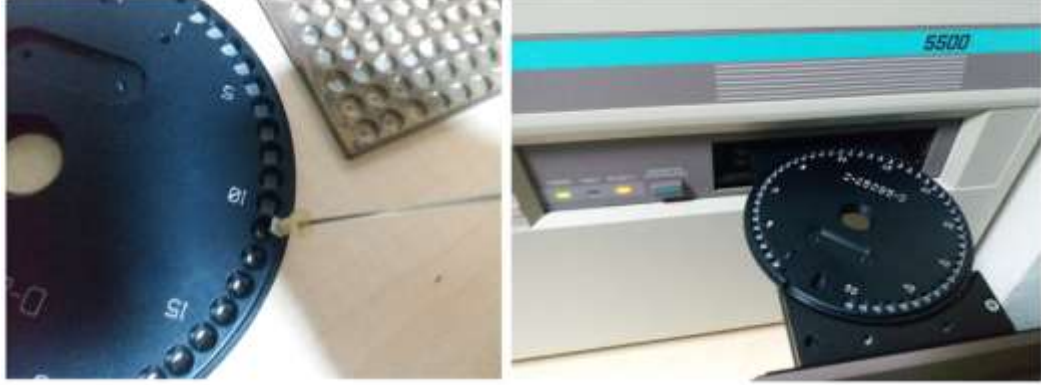
Şekil 55: TLD'lerin yüklerinin okuyucu kullanılarak belirlenmesi.
