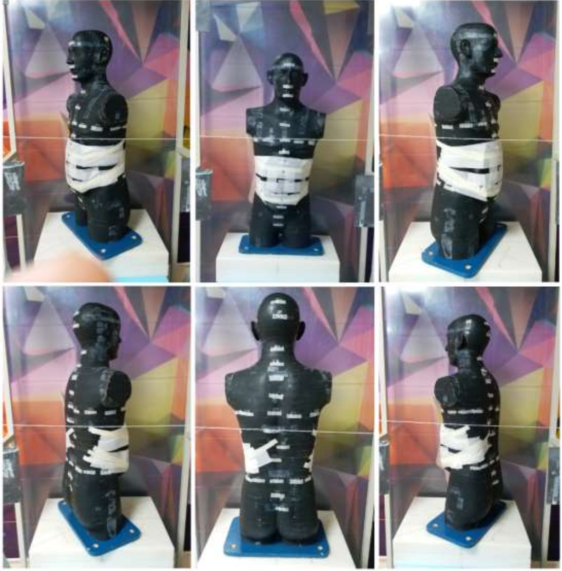
Şekil 218: 3 cm abdomen kalınlığı için bileşik doz ölçümü.
