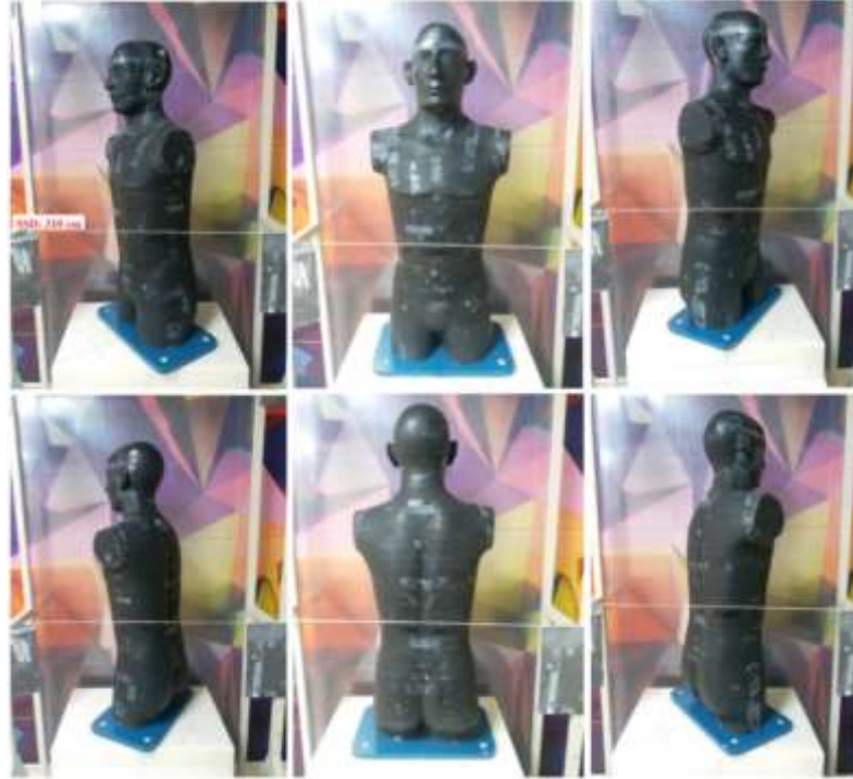
Şekil 143: TSEI fantom içi doz dağılımı ölçümü için ışınlama pozisyonları.
