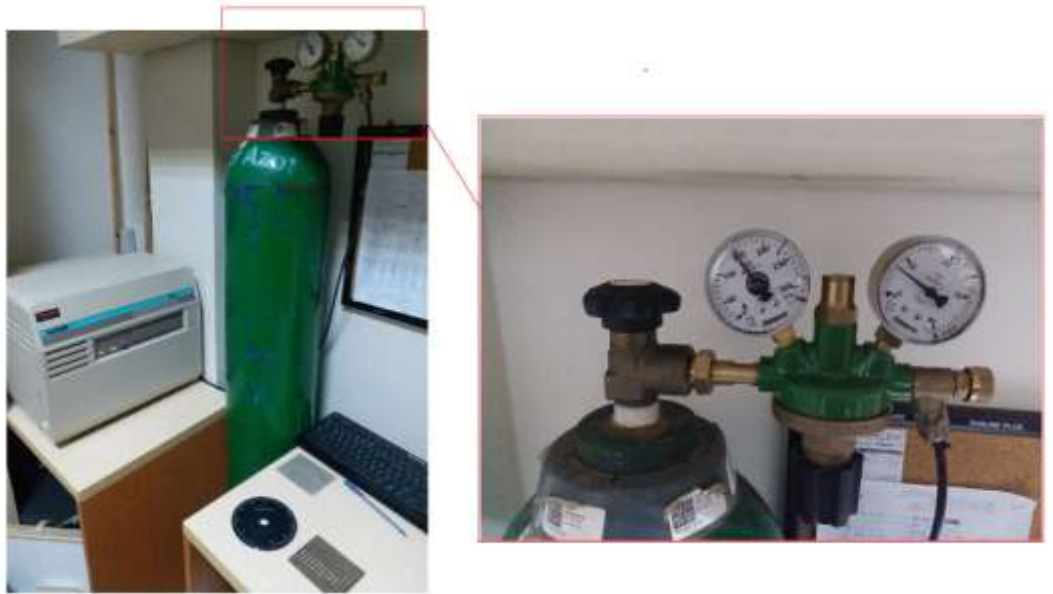
Şekil 32: TLD okuma sistemi.
