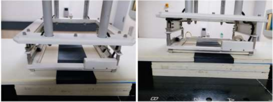
Şekil 99: RW3 ve siyah ABS için eş zamanlı profil ışınlaması.
