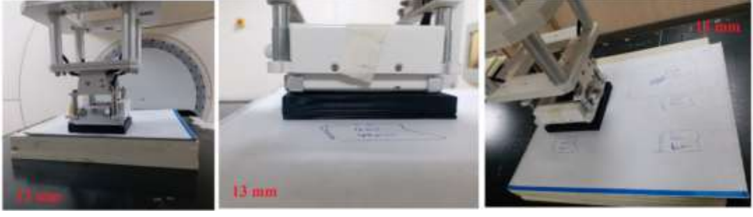
Şekil 94: Siyah ABS için 13 mm derinlikte düzlemsel doz ölçümü kurulumu.
