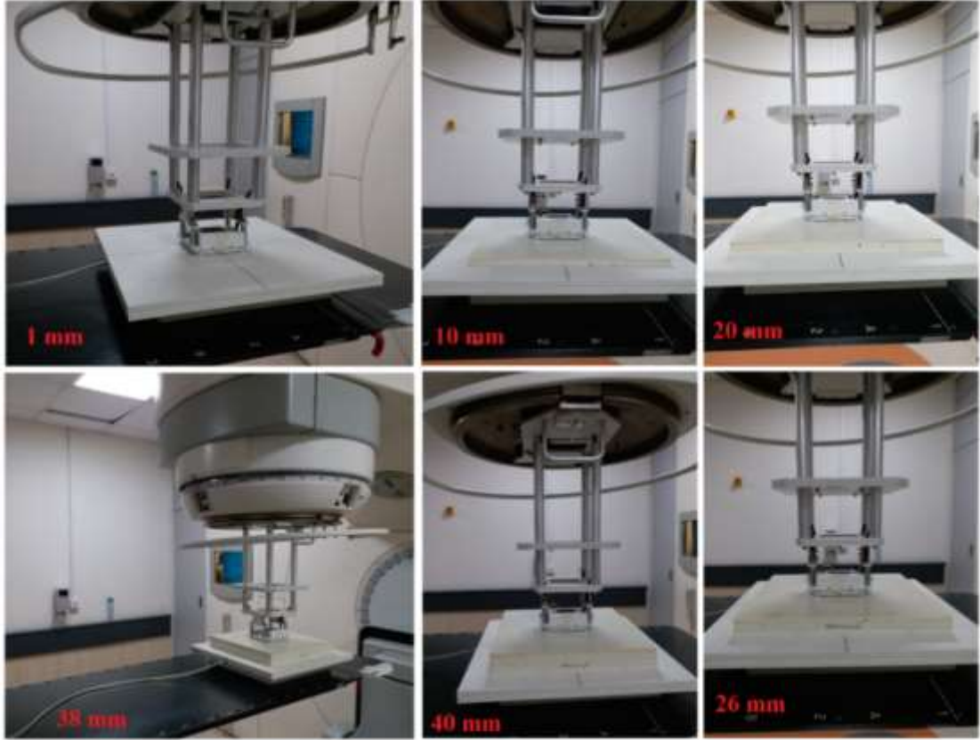
Şekil 82: RW3 katı fantomunda farklı derinlikler için doz ölçümü.
