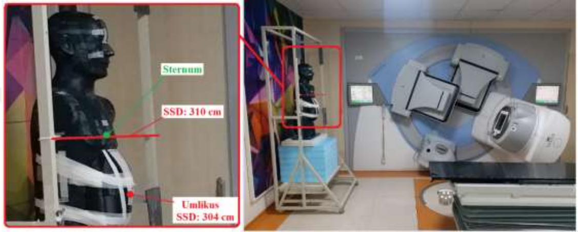
Şekil 198: 6 cm abdomen kalınlığında IM-TSEI için sternum noktasının SSD ayarlanmasında kullanımı.
