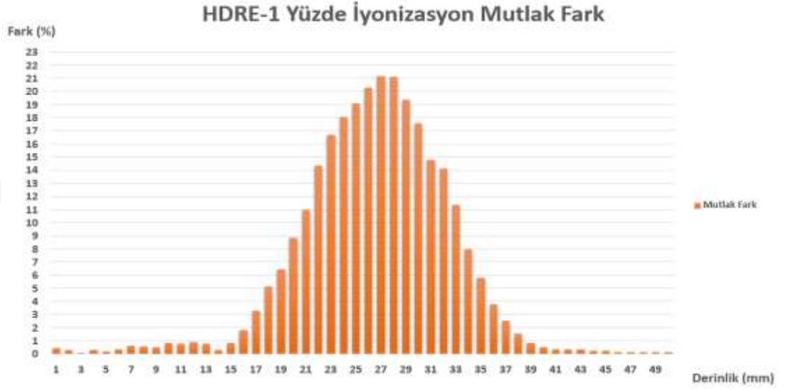
Grafik 10: Siyah ABS ve RW3 için SSD 310cm'de ölçümle elde edilen yüzde iyonizasyon eğrileri mutlak farkı grafiği.
