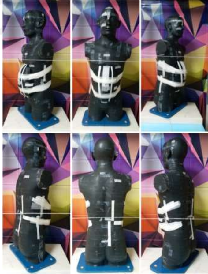
Şekil 255: IM-TSEI fantom cilt dozu ölçümü için ışınlama kurulumu.
