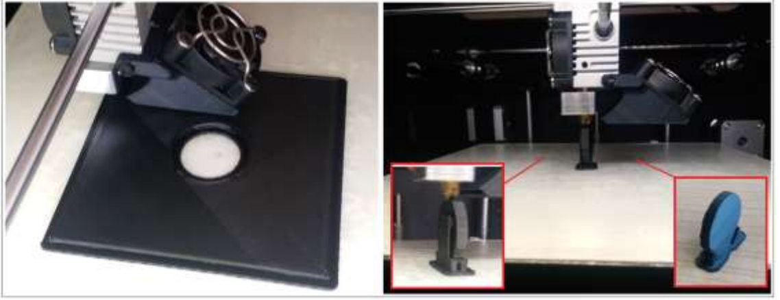
Şekil 64: Siyah ABS düz fantom ve aparatlarının üç boyutlu baskı işlemleri.
