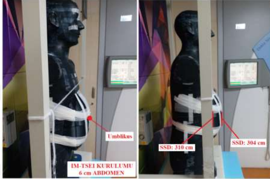
Şekil 197: IM-TSEI için umbilikus kalibrasyon noktasının cihaza yaklaşması.
