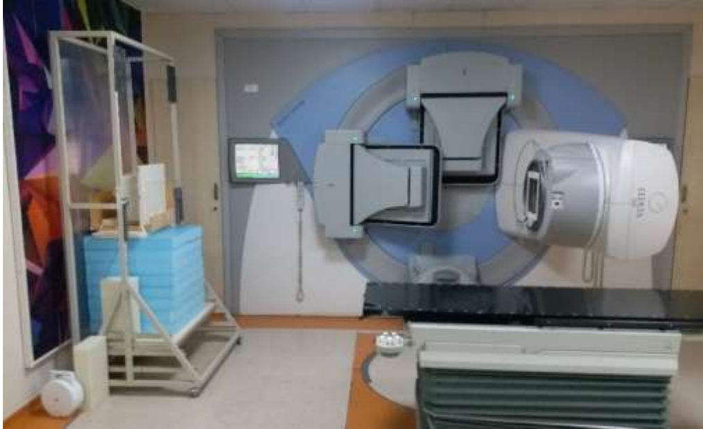
Şekil 87: RW3 fantomunda gantri 90°'de bir derinlik için doz ölçümü.
