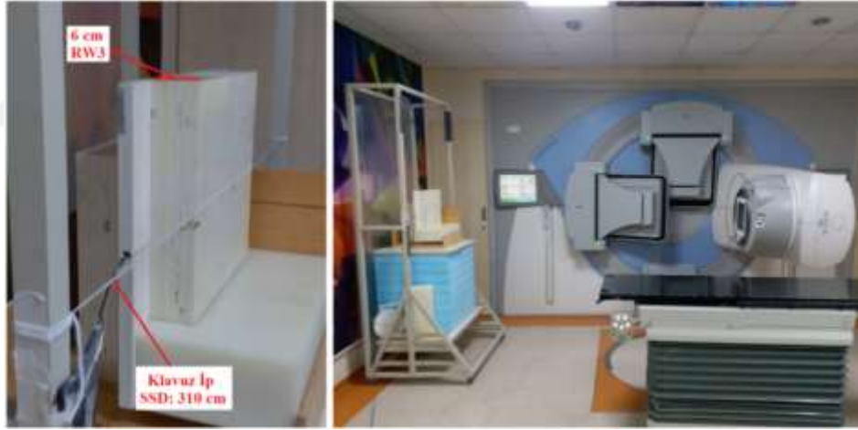
Şekil 157: Tek alan kontaminasyon için R_6 ölçümü kurulumu.
