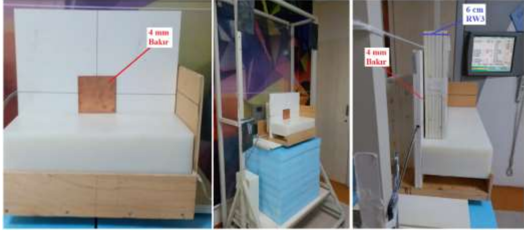
Şekil 155: 4 mm bakır için ışınlama kurulumu.
