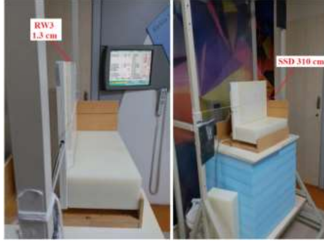
Şekil 156: Tek alan kontaminasyon için R_{maks} ölçümü kurulumu.
