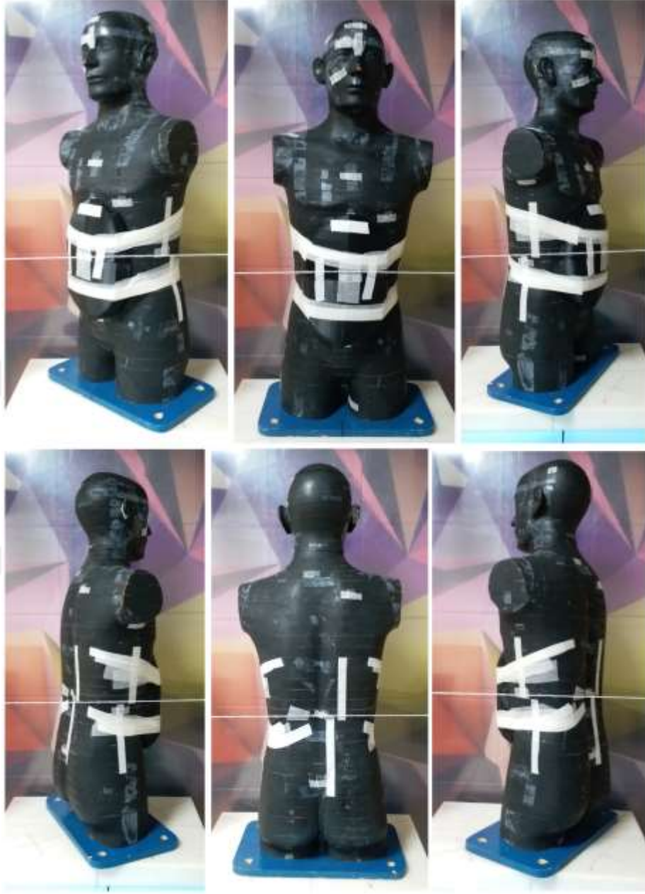
Şekil 257: TSEI fantom cilt dozu ölçümü için ışınlama kurulumu.
