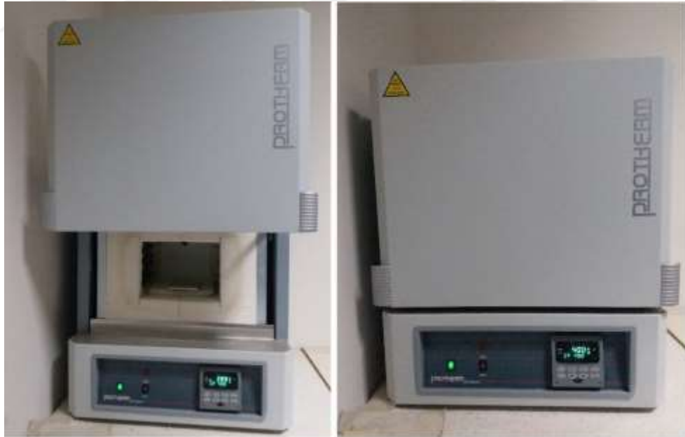
Şekil 54: TLD'lerin 400 °C'de 1 saat fırınlanması.
