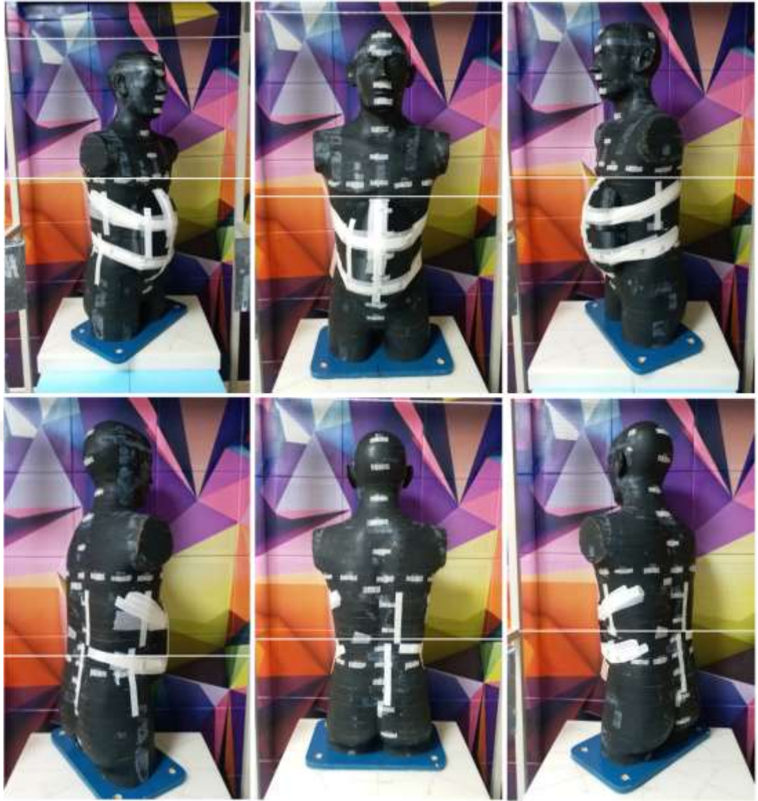
Şekil 219: 6 cm abdomen kalınlığı için bileşik doz ölçümü.
