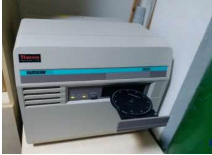
Şekil 33: TLD okuyucu 50 TLD'in aynı anda okunması.
