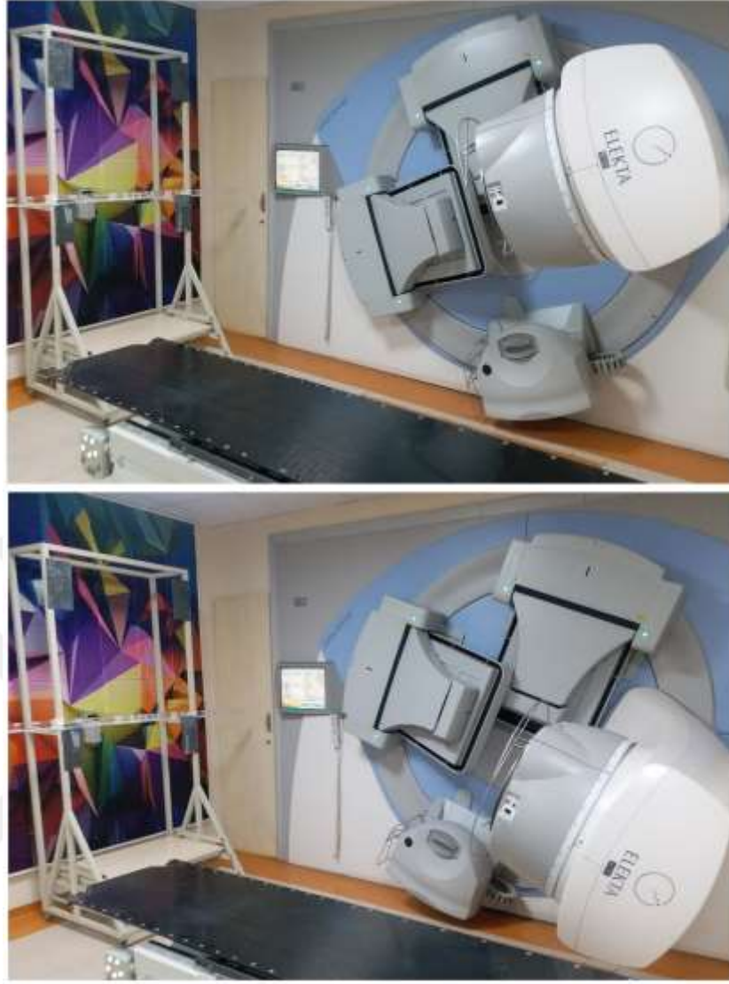
Şekil 107: 71°/109° açılı ışın çifti için yatay profil ölçümü.
