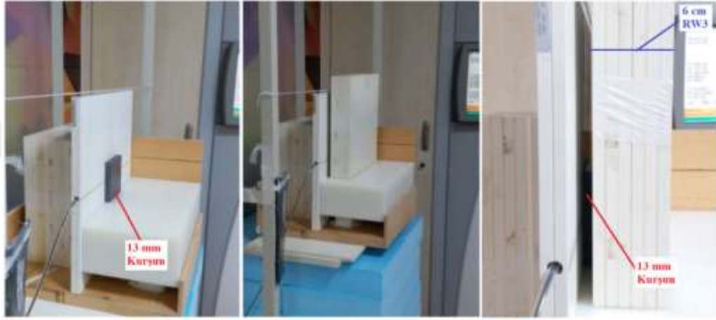
Şekil 154: 13 mm kurşun için ışınlama kurulumu.
