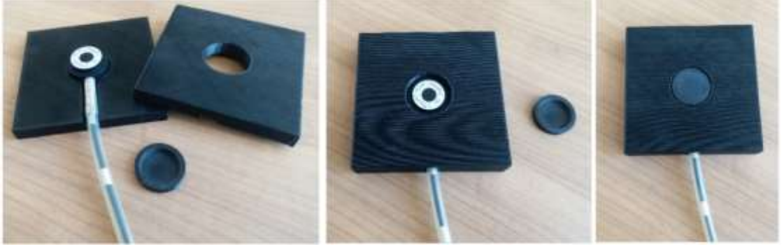
Şekil 66: Siyah ABS katı fantomlarının PPIC ile uyumunun kontrolü.
