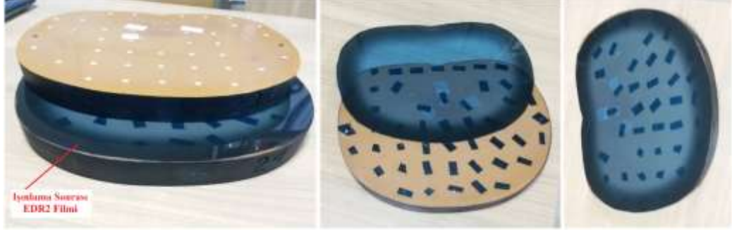
Şekil 146: EDR2 filminin ışınlama sonrası insan fantomu kesitleriyle uyumu.
