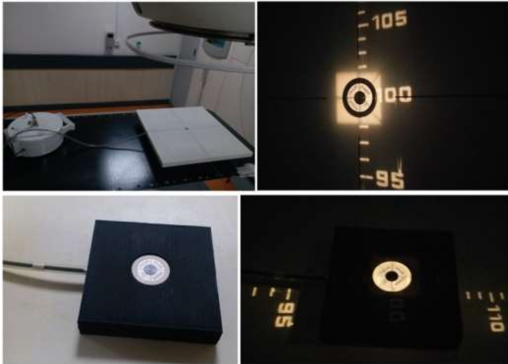
Şekil 68: RW3 ve ABS için TMR ölçümü SAD kurulumu.
