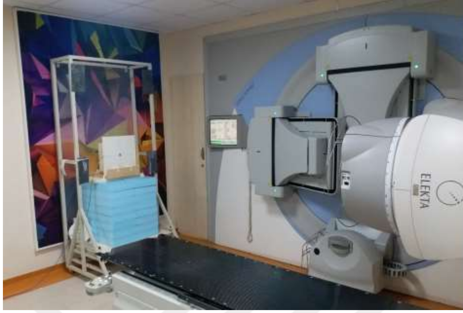
Şekil 12: Sıfır milimetre derinlik için %DD ölçümü kurulumu.
