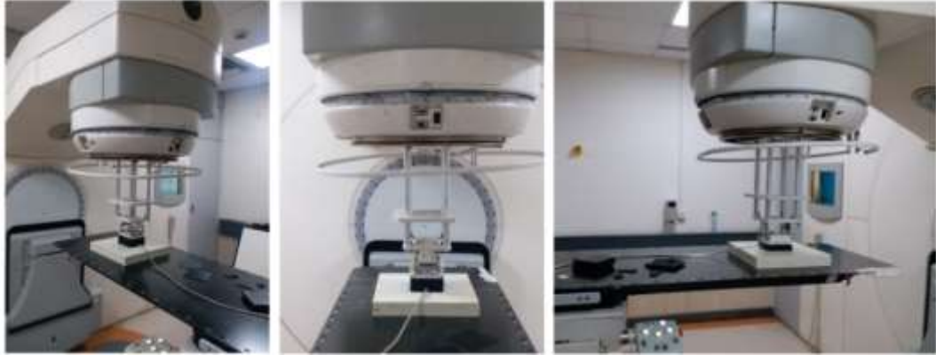
Şekil 79: Siyah ABS fantomunda bir derinlik için doz ölçümü.
