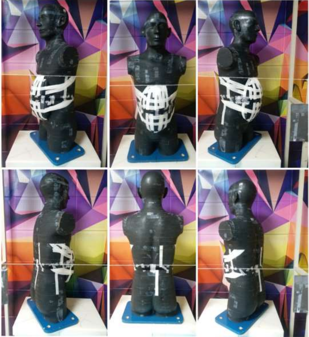
Şekil 246: IM-TSEI fantom içi doz dağılımı ölçümü için ışınlama kurulumu.
