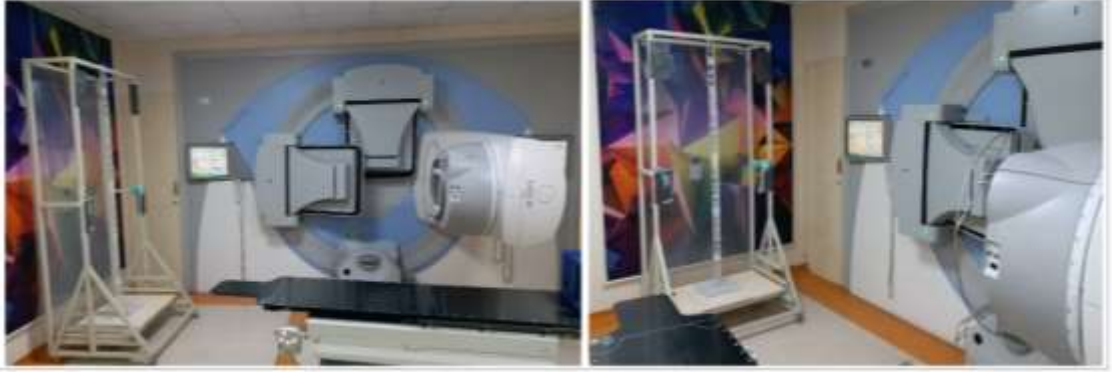
Şekil 111: Tek ışın vertikal profil ölçümü.
