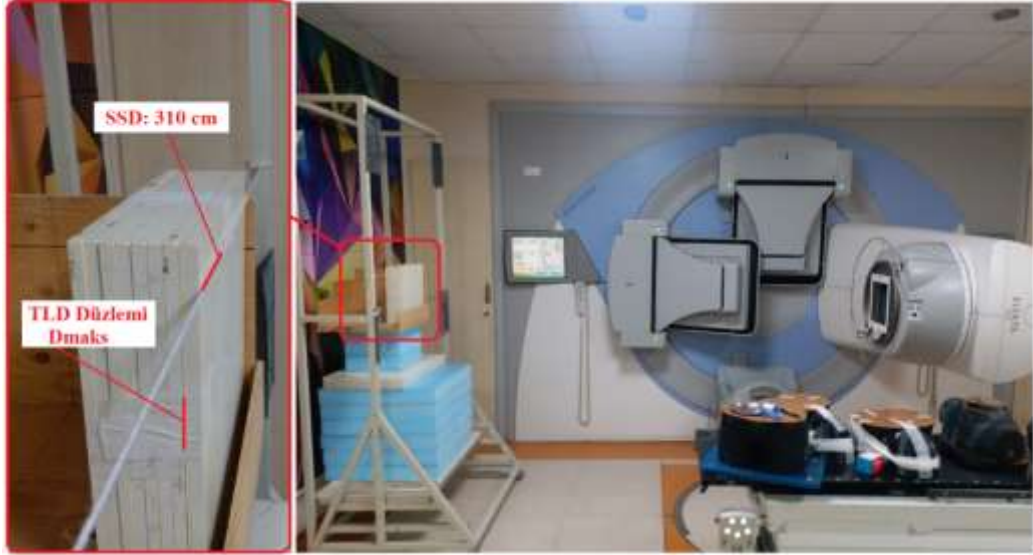
Şekil 13: TLD için doz kalibrasyon ölçümü kurulumu.
