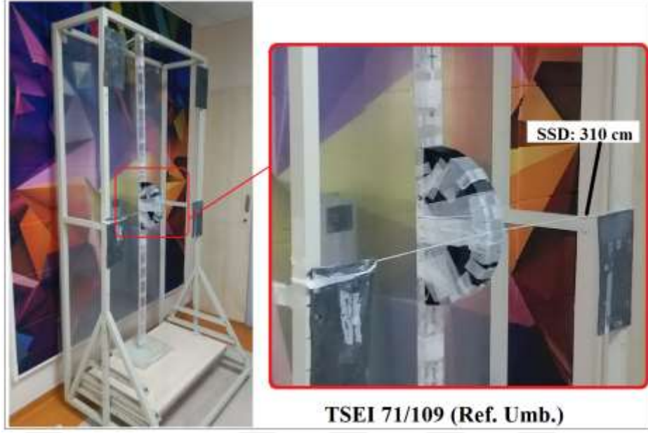
Şekil 239: Klasik TSEI tekniği için 12 cm kalınlığında abdomen fantomlu profil ölçümü kurulumu.
