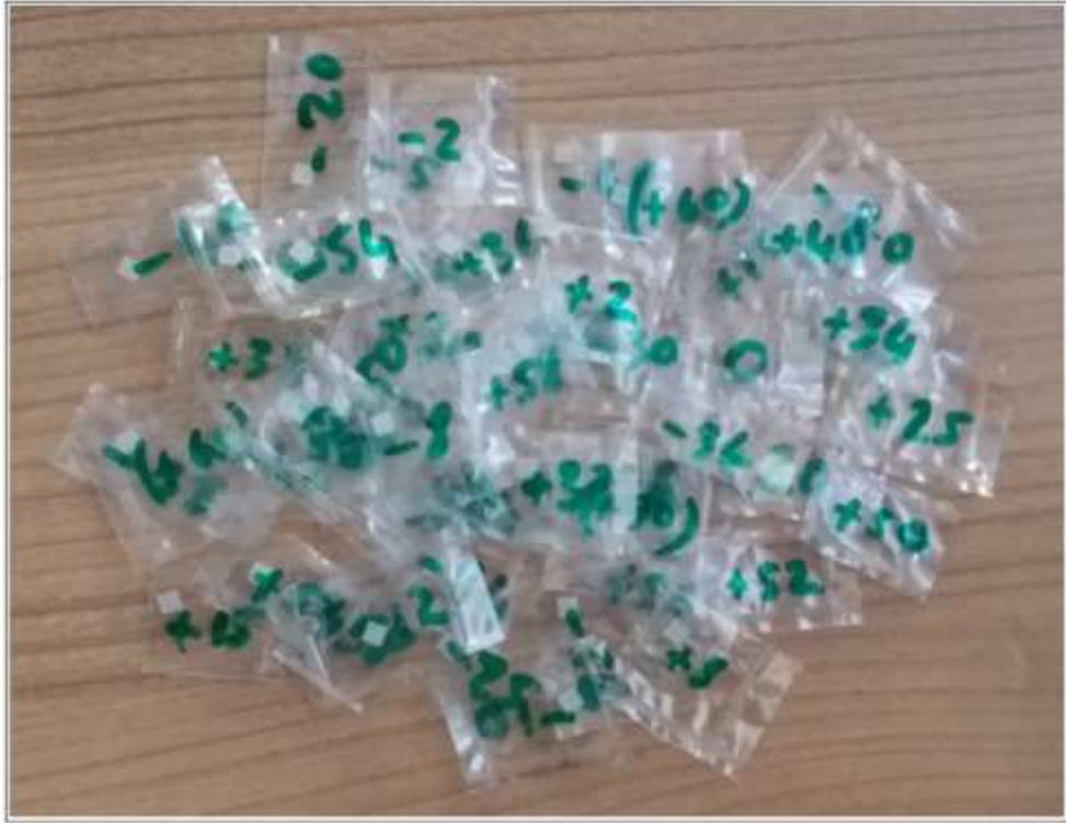
Şekil 108: Naylon poşetlerde paketlenmiş ölçüme hazır TLD'ler.
