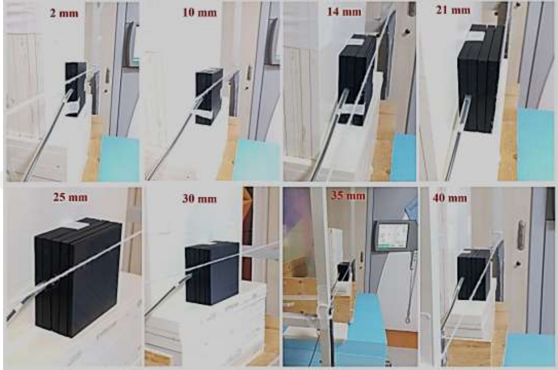
Şekil 85: Siyah ABS katı fantomunda gantri 90° de farklı derinlikler için doz ölçümü.
