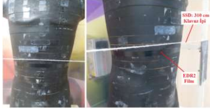
Şekil 142: İçine EDR2 filmi yerleştirilen insan fantomu için ışınlama kurulumu.
