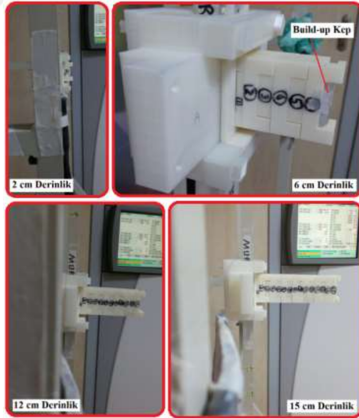
Şekil 214: Farklı abdomen kalınlıkları için derinlik doz deęişim ölçümü kurulumları.
