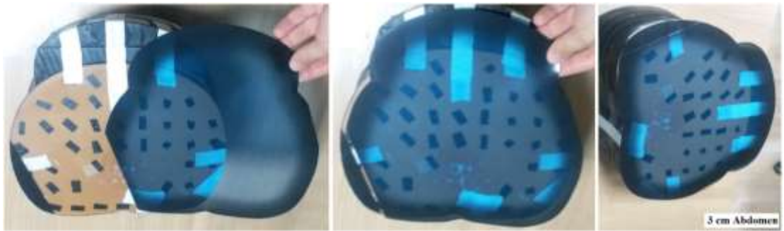
Şekil 251: EDR2 filmlerinin ışınlama sonrası insan fantomu kesitleriyle uyumu.
