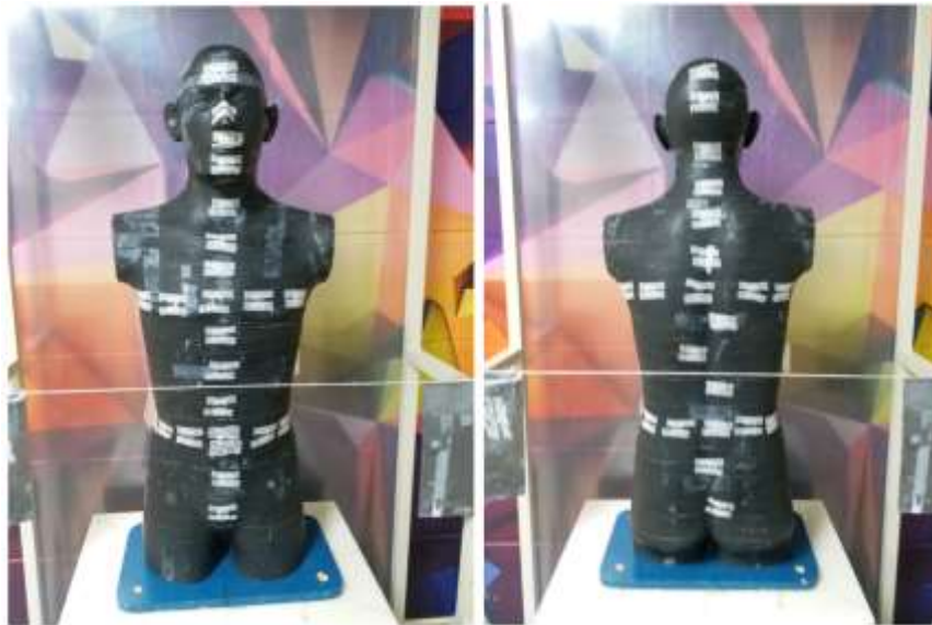
Şekil 14: Birleşik doz ölçümü kurulumu.
