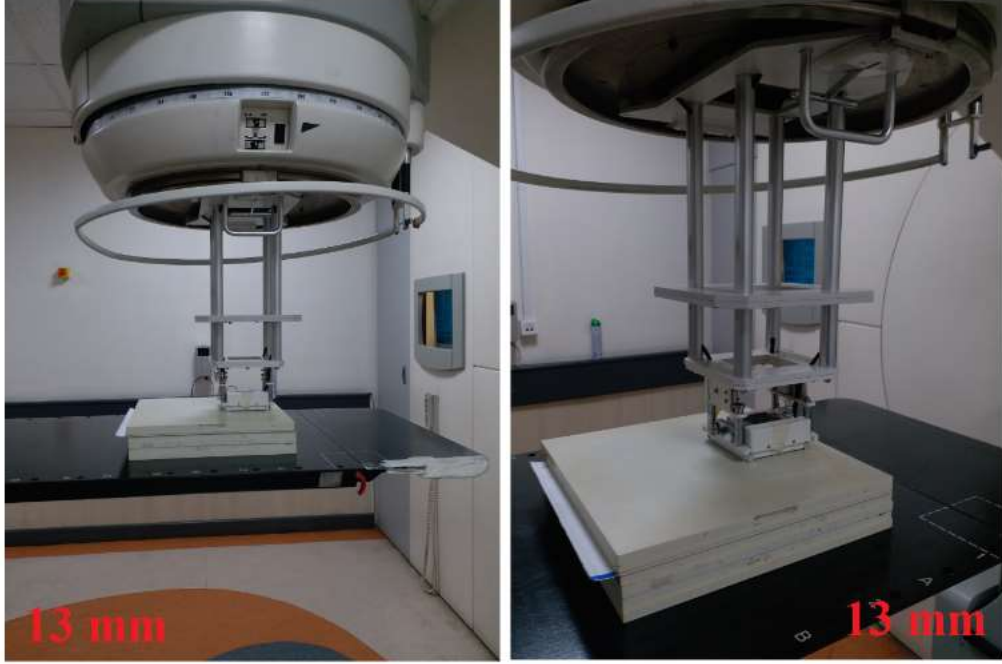
Şekil 95: RW3 için 13 mm derinlikte düzlemsel doz ölçümü kurulumu.
