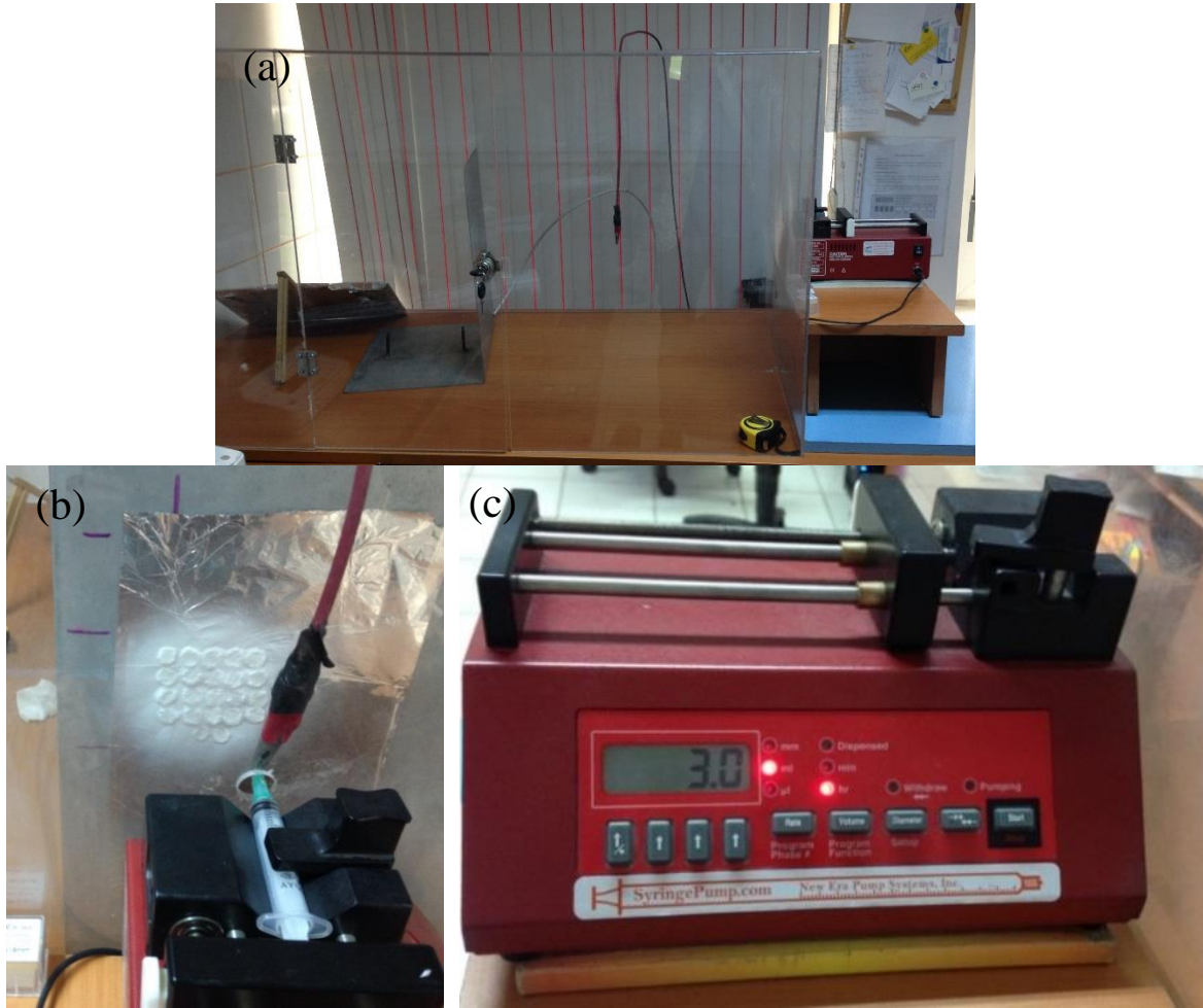
Resim 3-3. a. Elektro-eğirme düzeneği b. Şırınga yardımıyla PCL-COL çözeltinin elektro-eğirme düzeneğinde doku iskelelerine toplanması c. Enjektör (dozaj) pompasının değerlerinin ayarlanması
