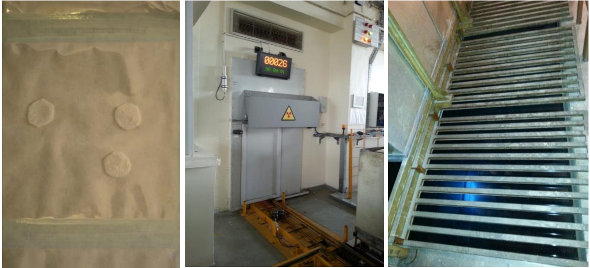
Resim 3-4. Tıbbi sterilizasyon amacıyla paketlenen membranlar ve Gamma Radyasyon Odası (TAEK)
