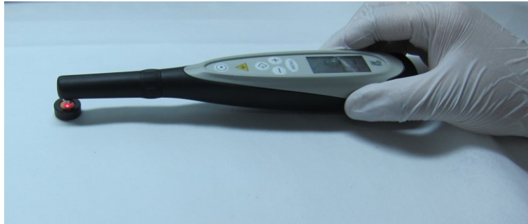
Resim 3.12. Cihazın porselen diski ile kalibrasyonu
