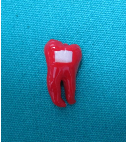
Resim 3.10. Dişin 3 \times 3 \text{ mm}^2 lik alanının açıkta kalacak şekilde tırnak cilası ile kaplanmış görüntüsü.
