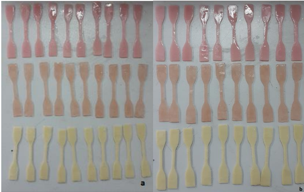
Resim 3.1. a. Termal siklus uygulanmayan örnekler yukarıdan aşağıya sırasıyla PMMA, poliamid rezin, asetal rezin olarak sıralanmıştır. b. Termal siklus uygulanan örnekler yukarıdan aşağıya PMMA, poliamid rezin, asetal rezin olarak sıralanmıştır.
