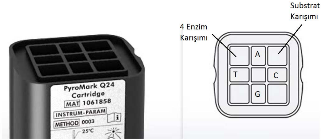
Şekil 3.7. Pyrosekans cihazının kartuşu (solda) ve kartuşa yüklenen sıvıların şeması (sağda)
