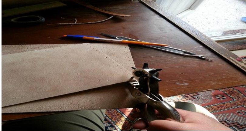
Şekil 78. Derinin çarklı zımba ile delinmesi
