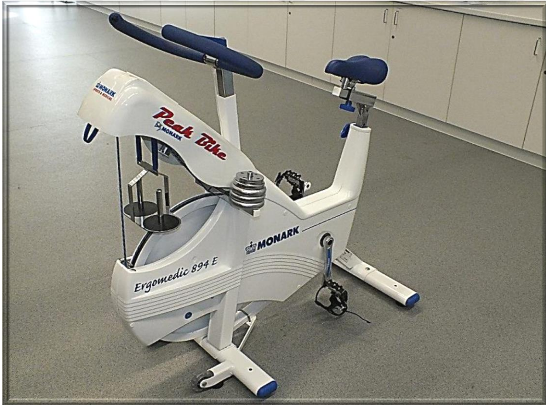
Resim 3.2. Wingate anaerobik güç ölçümü bisiklet ergometresi (monark 894 e)
