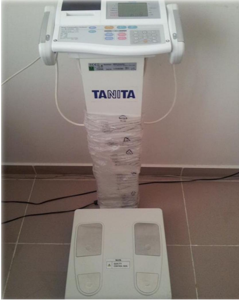
Resim 3.1. Biyoelektrik impedans analizi (BIA) ölçüm cihazı (Tanita bc 418 ma )
