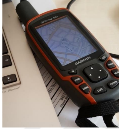
Şekil 4.1. Ocakların koordinatlarının belirlenmesinde kullanılan Garmin marka GPS cihazı.
