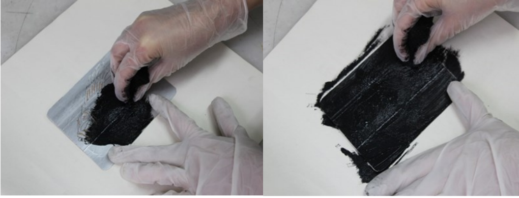
Şekil 41. Kalıba boya verilmesi ve boyanın çukur kısımlara yedirilmesi, tez uygulama sırasında çekilmiş dijital fotoğraf.
