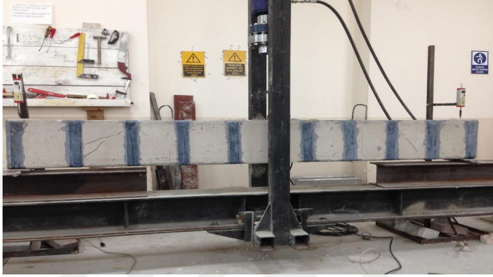
Şekil 4.9. Hasar sonrası 3 nolu deney elemanı.
