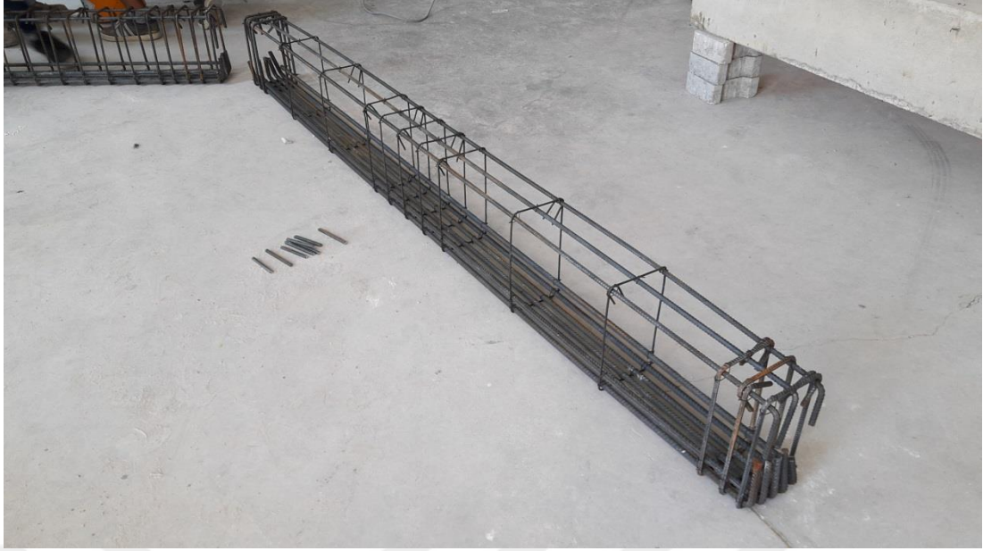
Şekil 3.7. Hazırlanan donatı kafesi.
