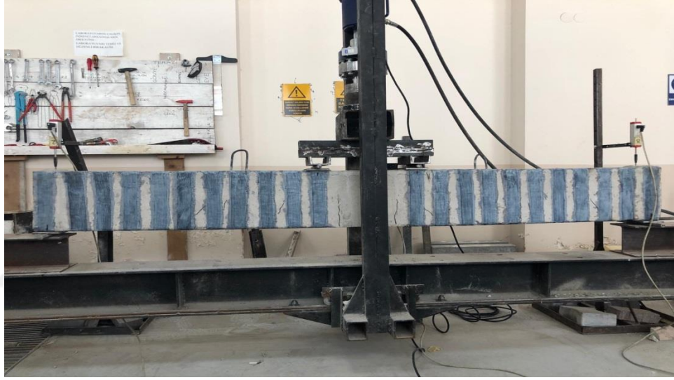
Şekil 4.26. Hasar sonrası 5 nolu deney elemanı.
