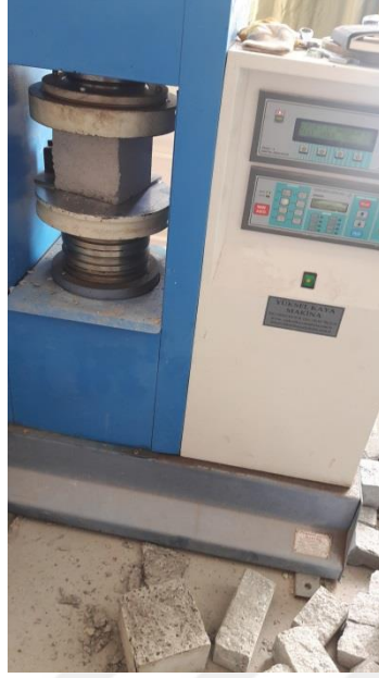
Şekil 3.11. K p numunelerin kırılması.
