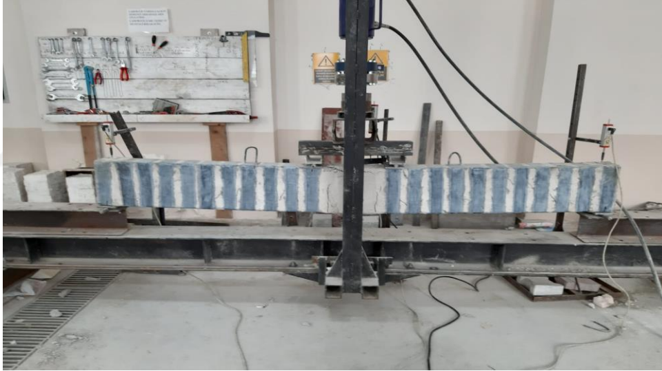
Şekil 4.37. Göçme sonrası 6 nolu deney elemanı.
