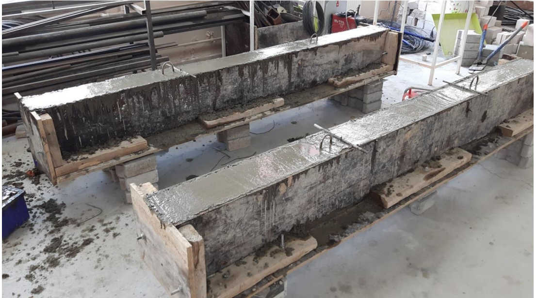
Şekil 3.10. Beton dökümünün gerçekleşmesi.
