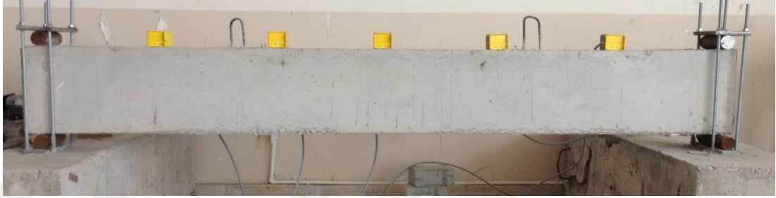
Şekil 4.5. Frekans ölçüm düzeneği ve ivmeölçer yerleşimi.
