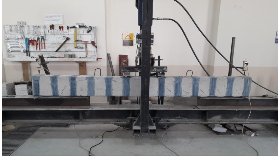
Şekil 4.18. Hasar sonrası 4 nolu deney elemanı.
