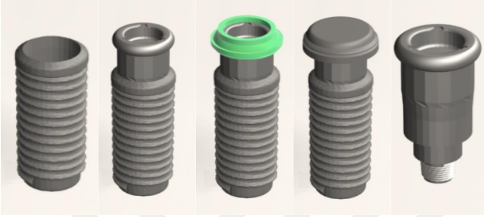
Resim 3.7. Çalışmada kullanılan implant, variobase, housing, matriks, novaloc modeli
