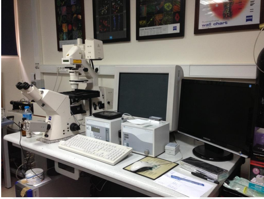
Şekil 3.15. Konfokal laser tarama mikroskobu (Zeiss lsm 510, Zeiss, ALMANYA)
