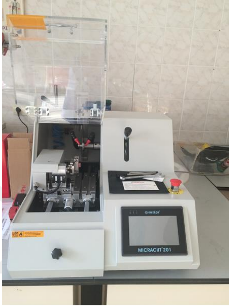
Şekil 3.9. Su soğutması ile çalışan mikro kesme cihazı (Micracut 201, Metkon, Bursa, Türkiye)
