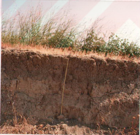
Foto 4: Beyoba köyünün 500 m. doğusunda horizon gelişimi gösteren (A-B) alüvyial toprak profili. A horizonu 60 cm. kumlu-killi-tın tekstürlü olup, B horizonu 50 cm. ve killi-tın tekstürdedir. HCl asitle yapılan işlemde çok şiddetli köpürme göstermektedir.
