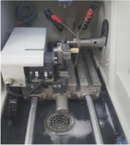
Resim 3.3. Düşük hızda kesit alma cihazıyla örneklerin 10 X 10 X 1.5 mm boyutlarında hazırlanması
