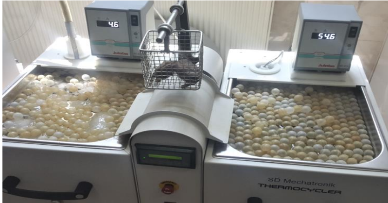
Resim 3.16. Örneklere termal siklus işleminin uygulanması
