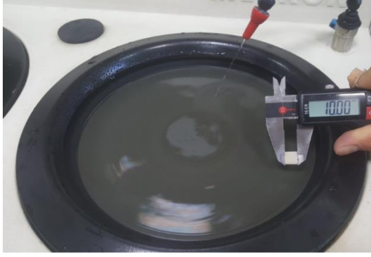
Resim 3.6. Örneklerin kenar ölçümlerinin dijital mikrometre ile yapılması
