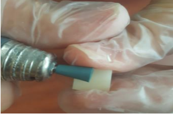
Resim 3.14. Örnekler polij işlemi uygulanması
