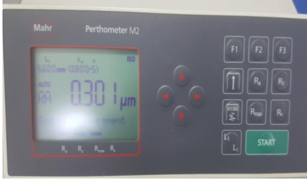
Resim 3.10. Profilometre cihazı ile yüzey pürüzlülüğü (Ra) değerlerinin ölçülmesi
