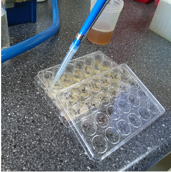
Resim 3.3. Örneklerin üzerine %5 sükröz çözeltisi eklenmesi
