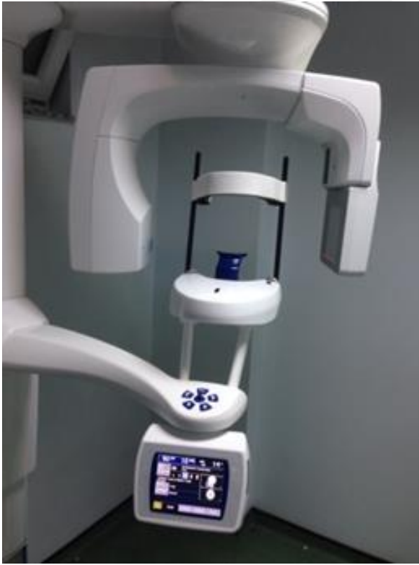
Resim 2.1. Planmeca Promax 3D konik ışınli bilgisayarlı tomografi cihazı
