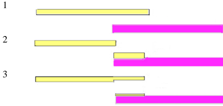
Şekil 3.2. Çalışmada kaydedilen başarısızlık tipleri. 1. Adeziv tip, 2. Koheziv tip (Kopma) ve 3. Koheziv tip (Yırtılma)
