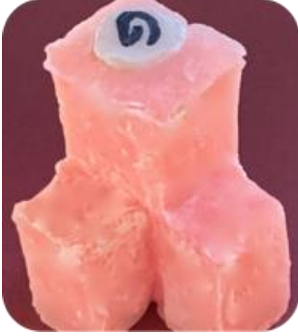
Resim 3.16. Soğuk akrile gömülen örneğin görüntüsü
