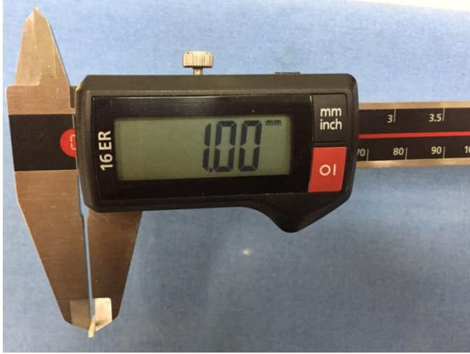
Resim 3.17. Mikro örnek boyutlarının kumpas ile ölçülmesi
