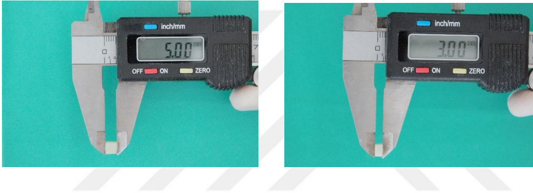
Resim 3.1. Örnek boyutlarının dijital kumpas ile kontrolü
