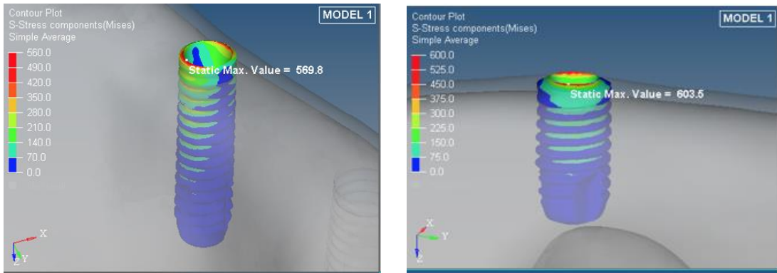
Şekil 4.8. Model 1’de oblik yüklemde implantların üzerinde oluşan Von Misses değerleri
