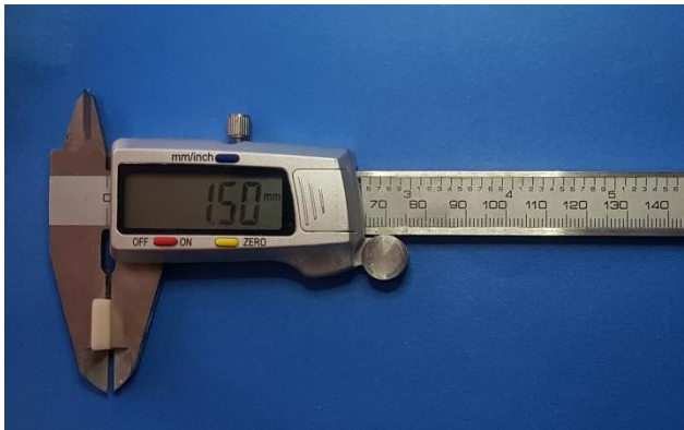
Resim 3.8. Dijital Kumpas İle Örneklerin Kalınlıklarının Ölçülmesi
