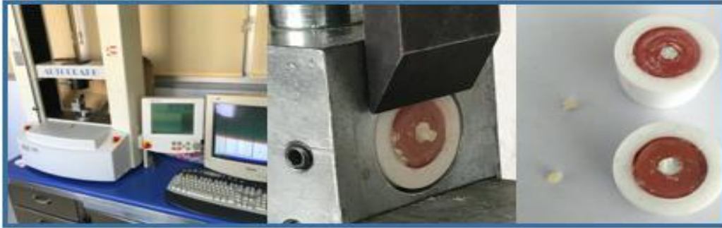
Resim 3.14. Kompozit materyal ve kalsiyum silikat bazlı simanların Shimadzu AG-IS Autograph cihazı ile bağlanma dayanımı ölçümü
