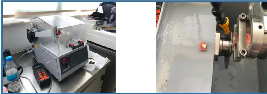
Resim 3.31. ATM Brilliant 210 Microcut cihazı ile kesit alınması
