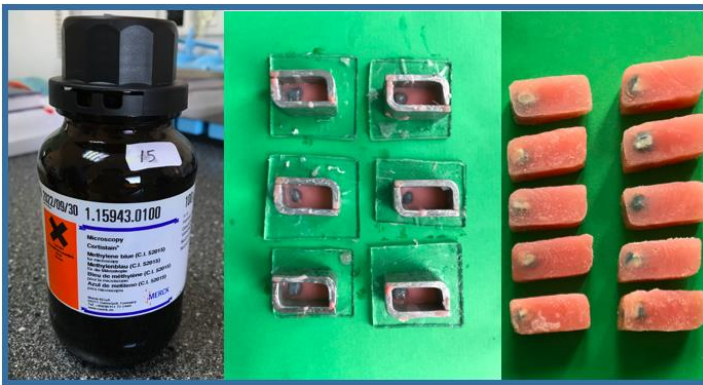
Resim 3.30. %2 metilen mavisi ve örneklerin akrilik bloklara gömülmesi
