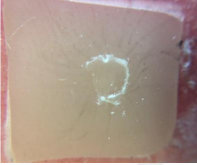
Resim 4.2. Materyal yüzeyinde siman tabakası mevcut olduğu kırık tipi (Tip 2)
