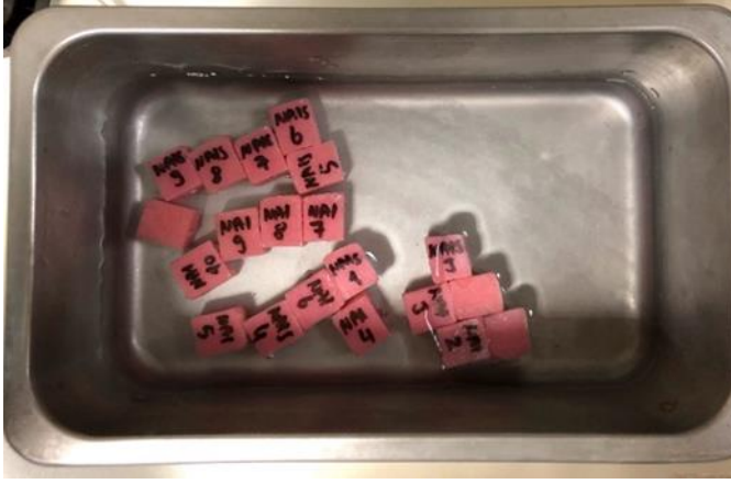
Resim 3.21. Örneklerin ultrasonik temizleme cihazıyla temizlenmesi
