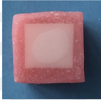
Resim 3.15. HF asit sonrası yıkayıp kurutulmuş örnek yüzeyleri
