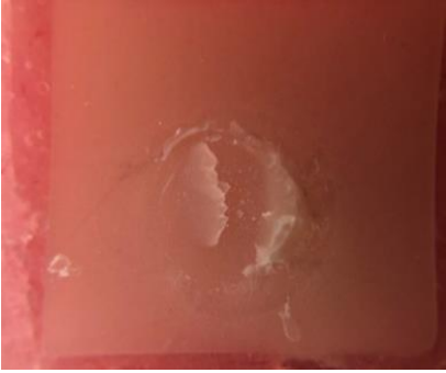
Resim 4.3. Materyalin bir kısmı siman ile birlikte koptuğu kırık tipi (Tip 3)
