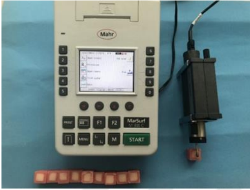
Resim 3.22. Örneklerin yüzey pürüzlülüğünün ölçülmesi
