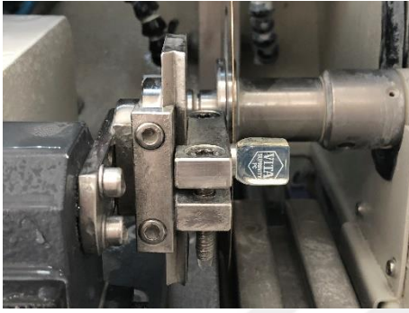
Resim 3.4. Vita Suprinity örneklerin kesilmesi
