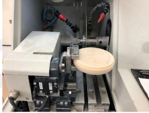
Resim 3.9. Nacera Hybrid örneklerin kesilmesi
