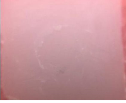
Resim 4.1. Materyal yüzeyinde siman tabakasının olmadığı kırık tipi (Tip 1)
