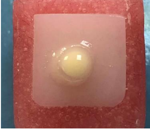
Resim 3.25. Örneklere simanın yerleştirilmesi
