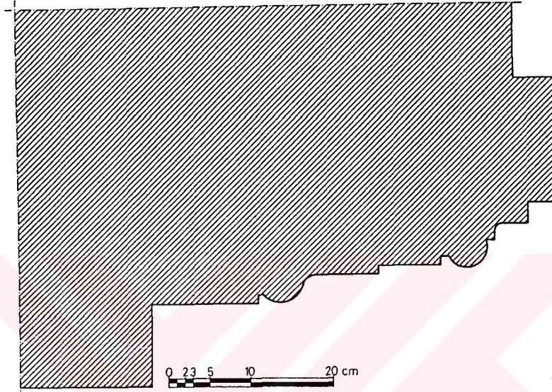
Şekil 39- Bursa Yeşil Medrese. Pencere profili.
