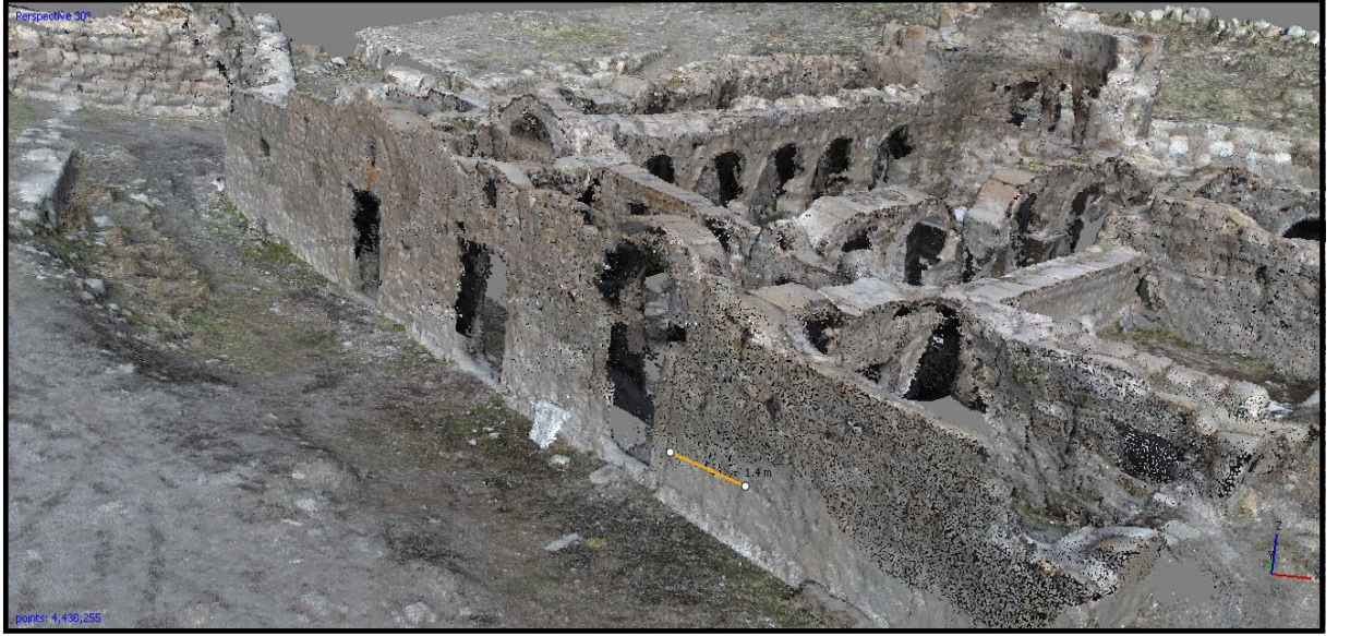
Şekil 4.18. Çalışma alanındaki taş büyüklüklerinin Agisoft Photoscan Professional yardımıyla 3B model üzerinden ölçülmesi.
