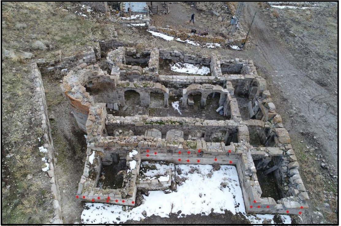
Şekil 4.9. Yapıya ilişkin yan cepheye ait yapı kontrol noktaları ve kontrol noktalarının dağılımı.
