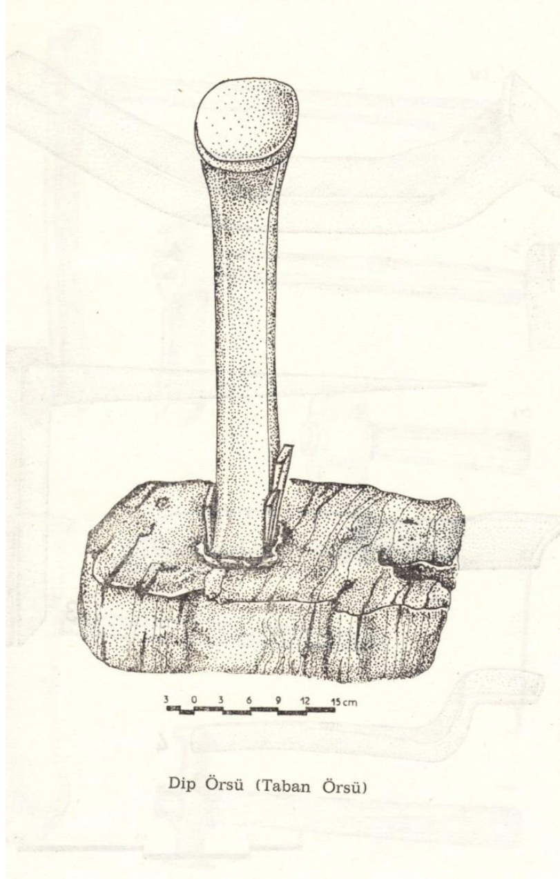
Çizim 5: Madeni Eşya Yapımında Kullanılan Örsler ( KAYAOĞLU,1984, s. 257).
