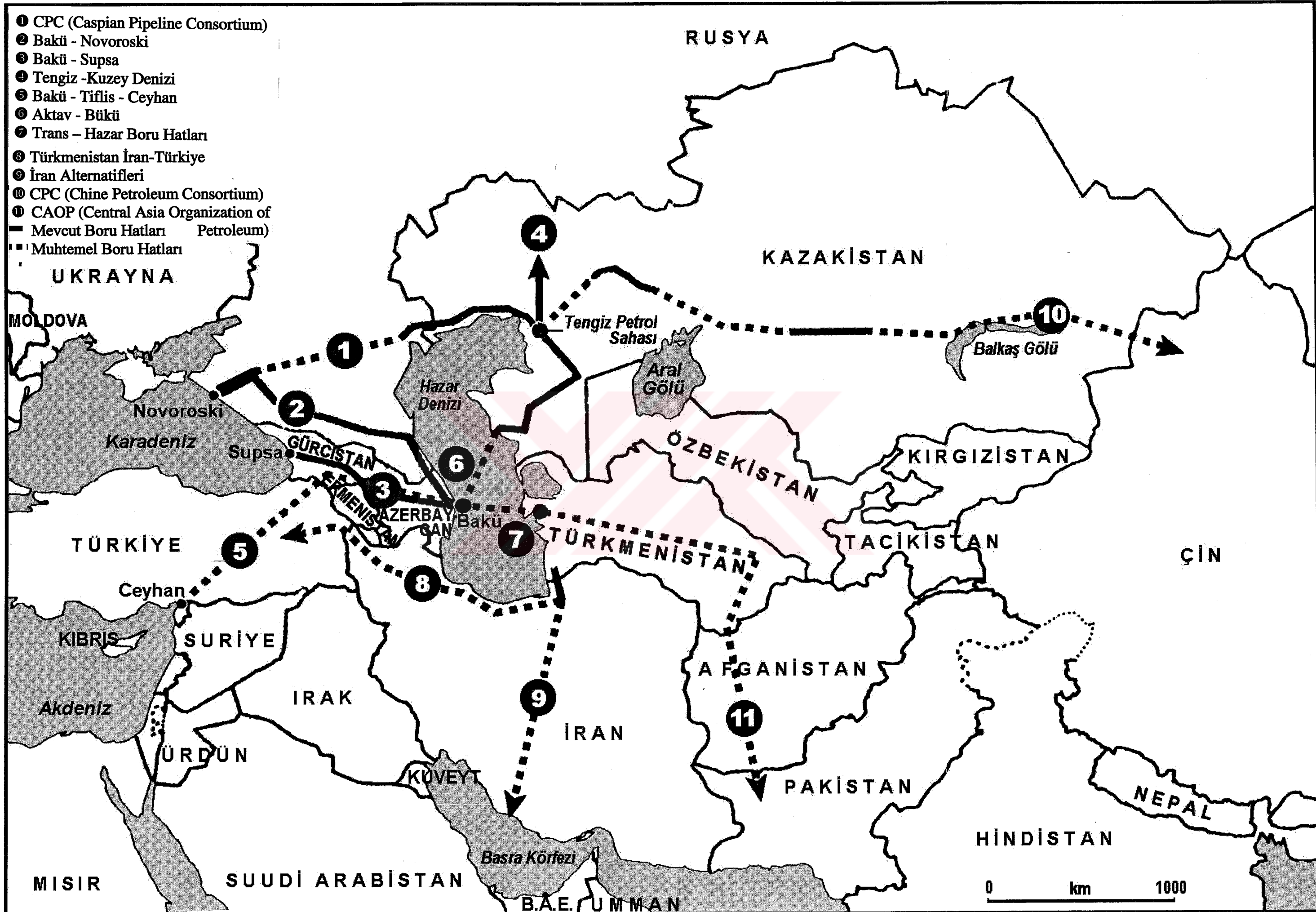
Şekil -5- Alternatif Boru Hattı Güzergahları
