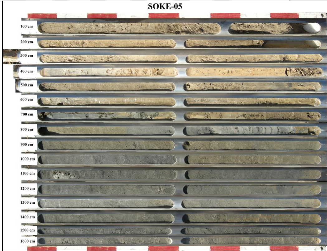
Foto 83: Söke – 05 numaralı sondaj çalışmaları (üstte) ile bu sondaja ait sedimanlar (altta).
