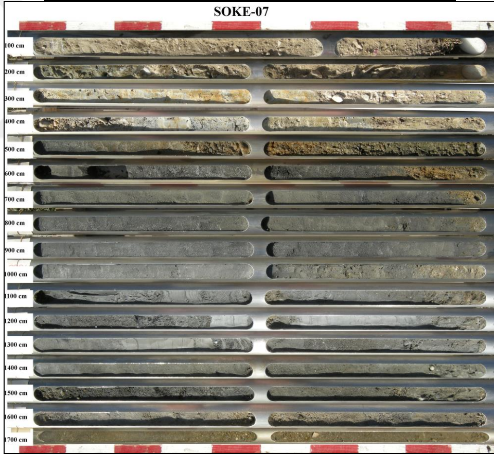
Foto 87: Söke – 07 numaralı sondaj çalışmaları (üstte) ile bu sondaja ait sedimanlar (altta).
