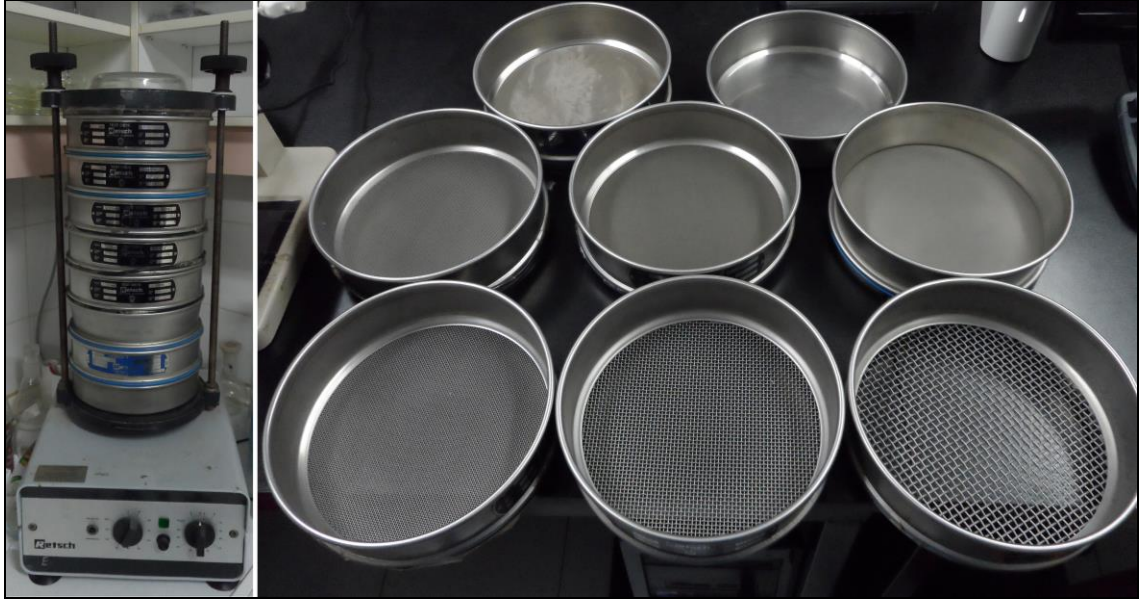
Foto 3: Kullanılan Restch marka elek sistemi ve farklı açıklıktaki elekler.
