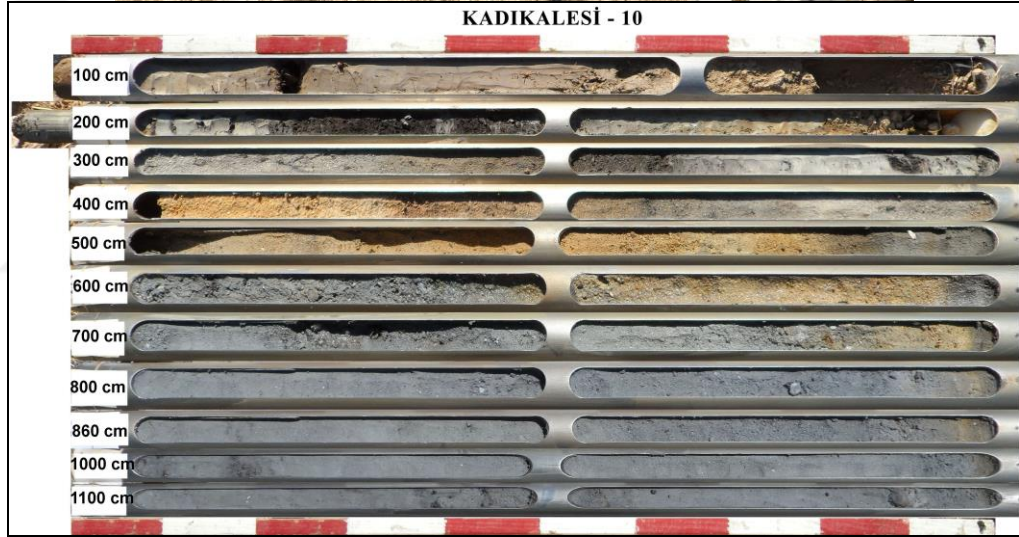
Foto 97: Kadikalesi - 10 numaralı sondaj çalışmaları (üstte) ile bu sondaja ait sedimanlar (altta).
