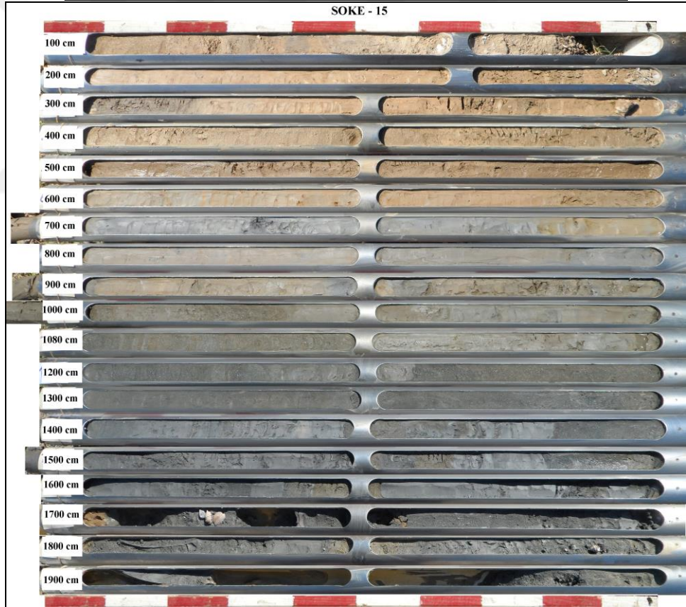
Foto 74: Söke – 15 numaralı sondaj çalışmaları (üstte) ile bu sondaja ait sedimanlar (altta).
