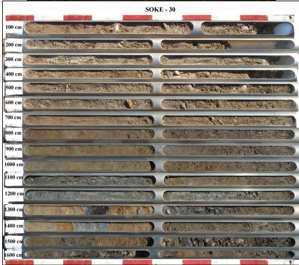
Foto 84: Söke – 30 numaralı sondaj çalışmaları (üstte) ile bu sondaja ait sedimanlar (altta).
