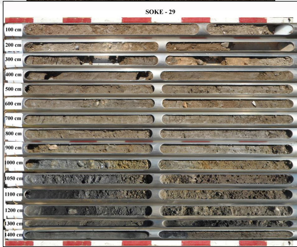
Foto 80: Söke – 29 numaralı sondaj çalışmaları (üstte) ile bu sondaja ait sedimanlar (altta).
