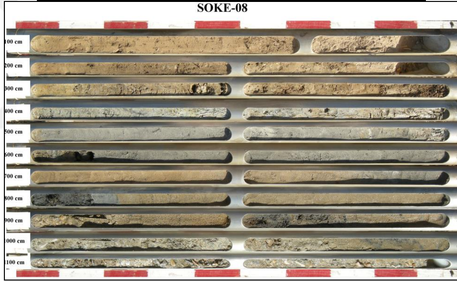
Foto 90: Söke – 08 numaralı sondaj çalışmaları (üstte) ile bu sondaja ait sedimanlar (altta).
