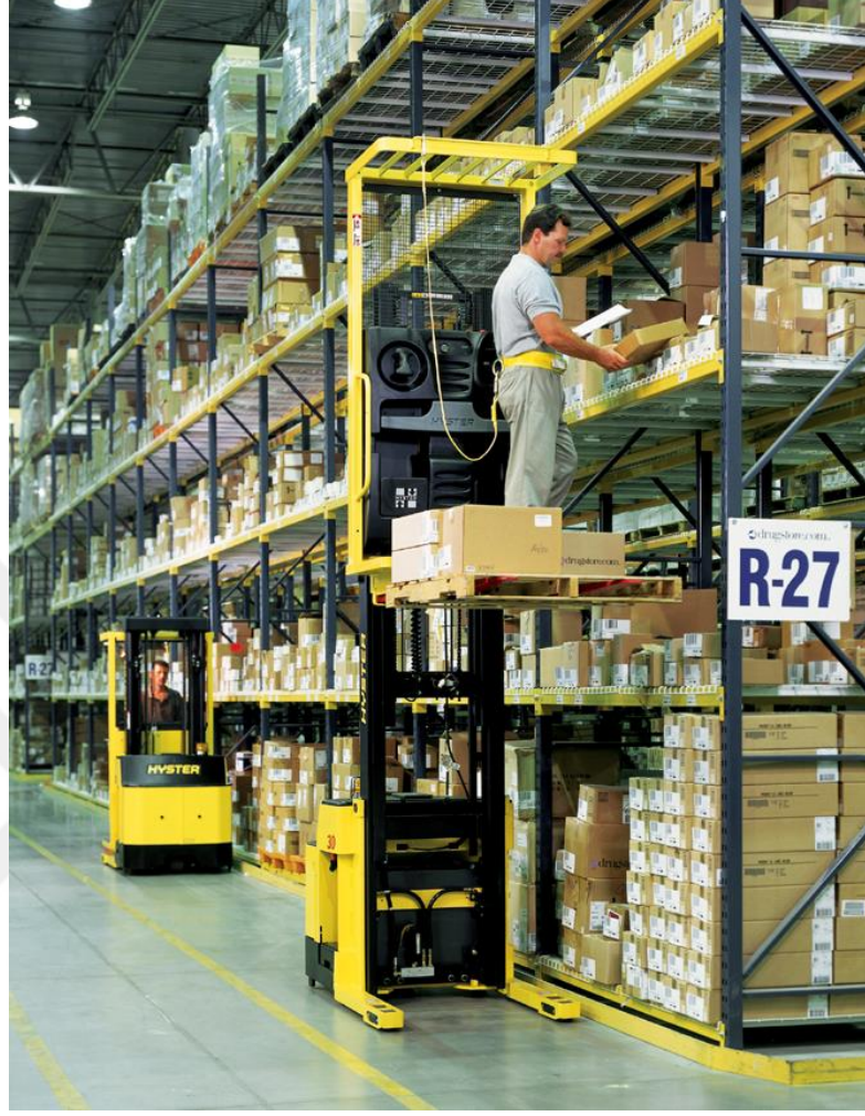
Şekil 2.13: Operatör kabinli bir OD/ÇS Kaynak: Soyaslan vd. 2015: 11
