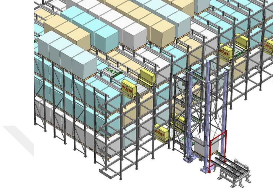
Şekil 2.14: Çok Derinlikli bir OD/ÇS Kaynak: Soyaslan, 2015: 11
