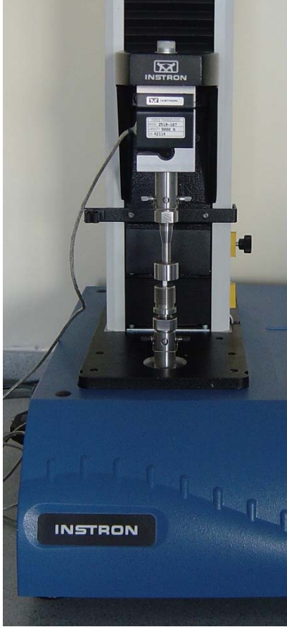
Resim 16. Örnekler INSTRON 3345 cihazında kırılarak başlangıç basma dayanıklılık değerleri elde edilmiştir
