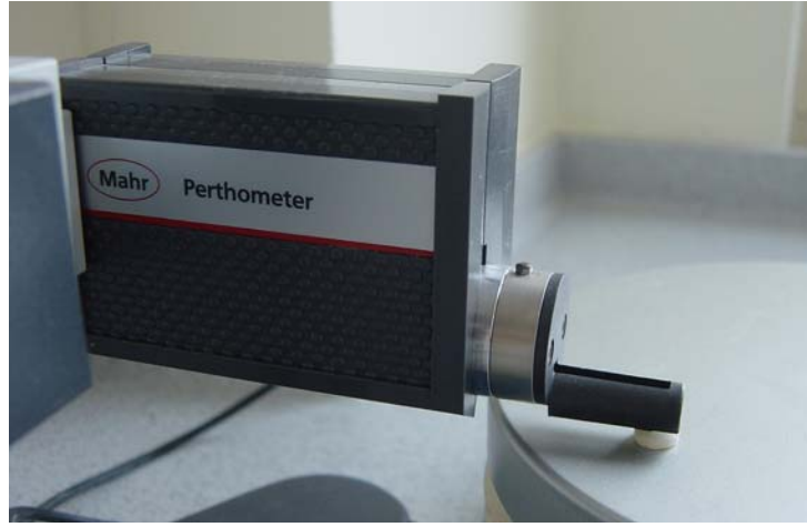
Resim 15. Örnekler yüzey profilometresinde (Mahr Perthometer M1) ölçülerek yüzey pürüzlülük değerleri elde edilmiştir
