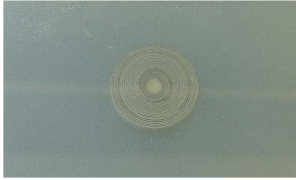
Resim 11. Asetat kağıdı ile kaplanmış iki siman camı arasında sıkıştırılarak hazırlanan örnekler
