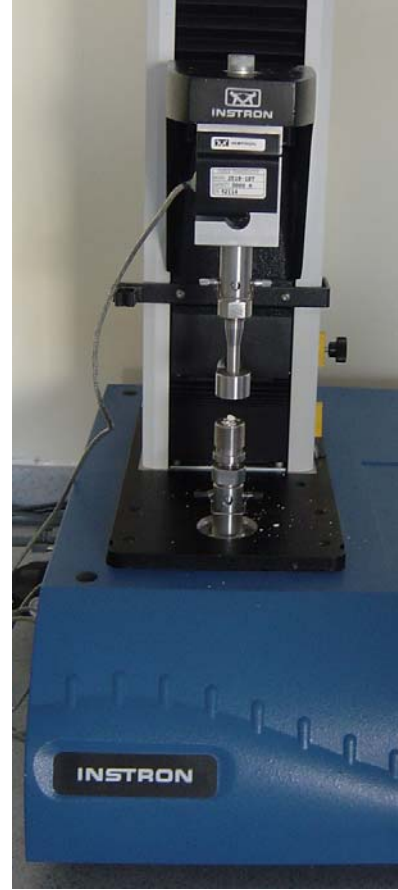
Resim 16. Örnekler INSTRON 3345 cihazında kırılarak başlangıç basma dayanıklılık değerleri elde edilmiştir
