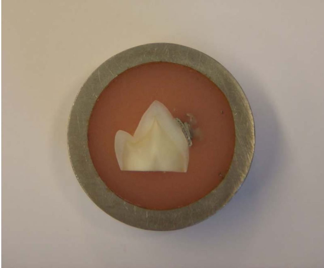
Resim 3.12. Akrilik içerisine gömülmüş kesit örneği
