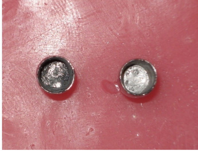
Şekil 3.8. Kumlama işlemi öncesi ve sonrasında kuronların iç yüzeyleri
