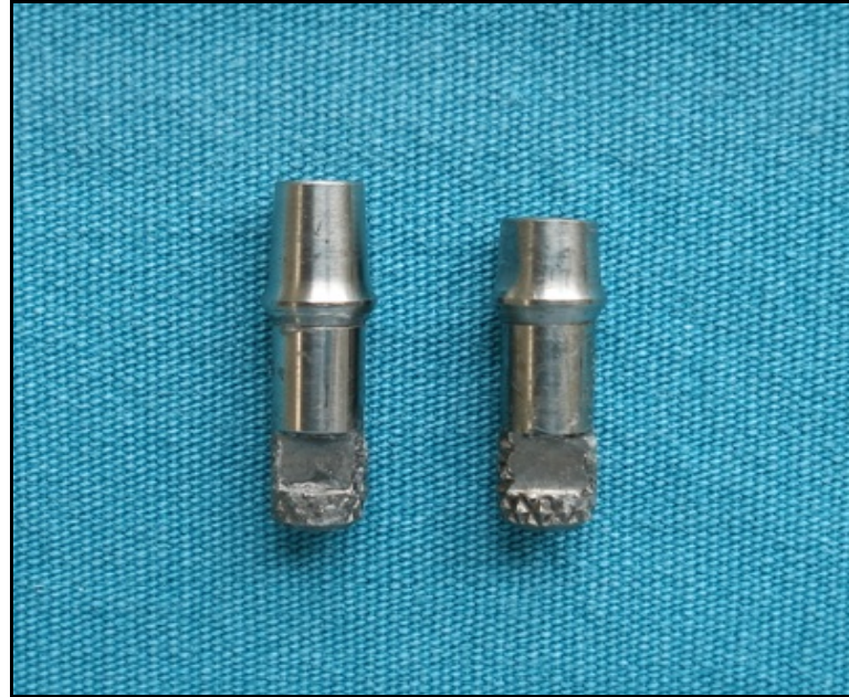
Şekil 3.6. İmplant analoglarına sabitlenen 4 mm ve 6 mm abutmanlar
