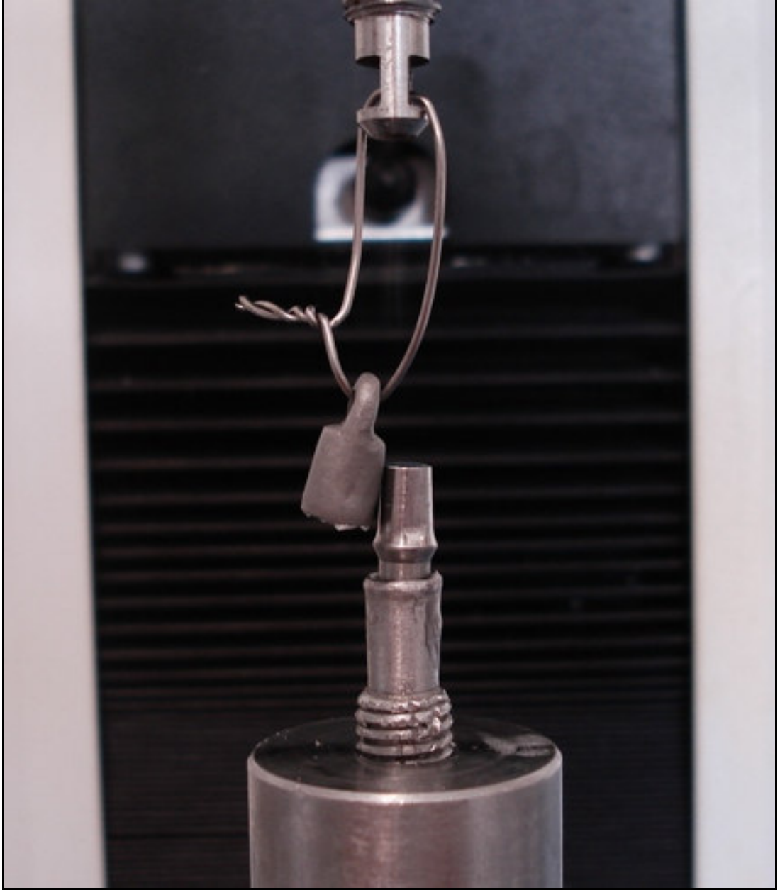
Şekil 3.16. Instron cihazında vertikal çekme işlemi uygulanmış deney örneği
