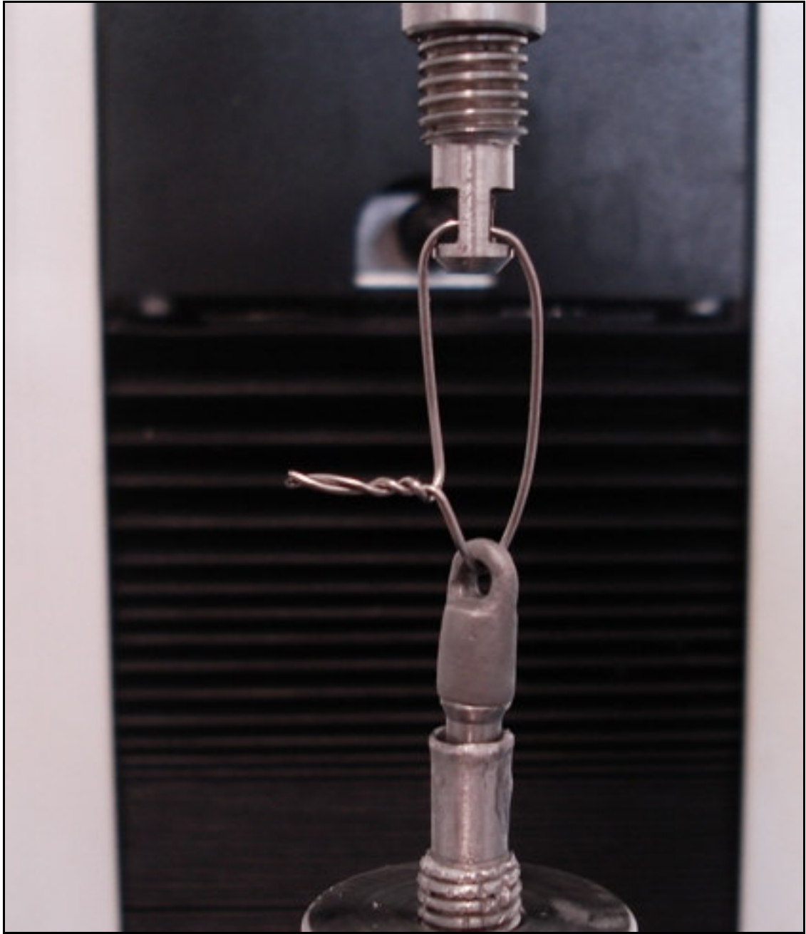
Şekil 3.15. Vertikal çekme işlemi öncesi deney örneğinin Instron cihazına sabitlenmesi
