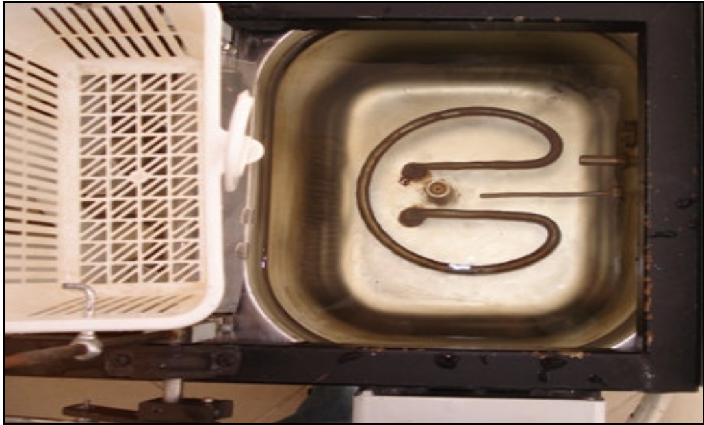
Şekil 3.11. Yaşlandırma işleminin uygulandığı su havuzu ve içinde bulunan termometre
