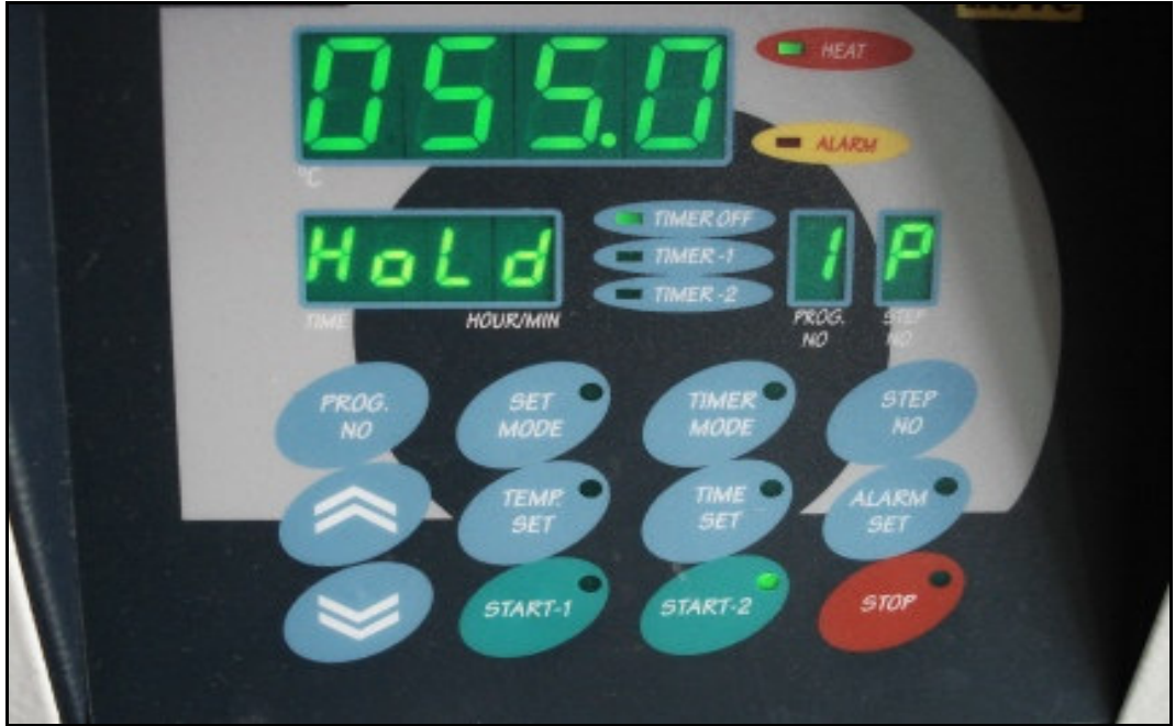
Şekil 3.13. Sıcak su banyosunun sıcaklığının programlandığı ve sıcaklığın izlendiği pano
