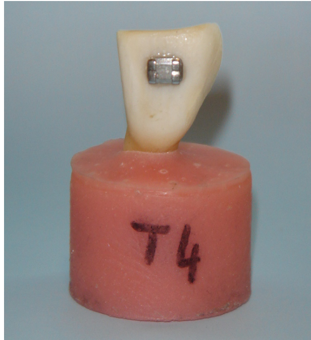
Resim 3.12. Akril blok içine alınmış ve adaptöre yerleştirilmeye hazır örnek.
