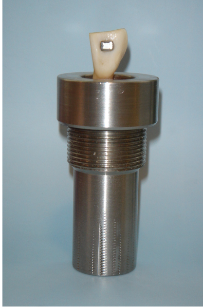
Resim 3.14. Akril bloklara gömülmüş dişlerin adaptöre yerleştirilmiş hali
