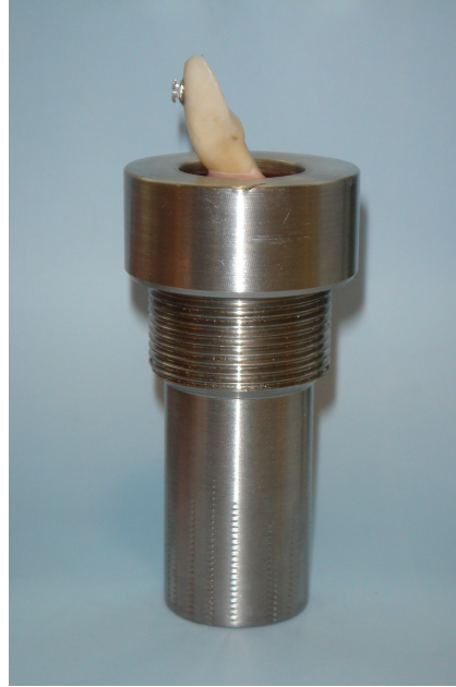
Resim 3.14. Akril bloklara gömülmüş dişlerin adaptöre yerleştirilmiş hali
