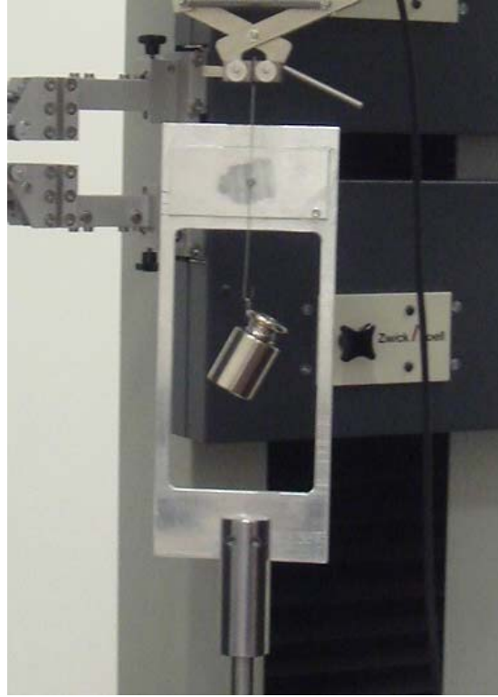
Resim 3.3. Deney düzeneđi; Zwick/Roell Test Cihazı ve braketin yerleřtirildiđi metal çerçeve
