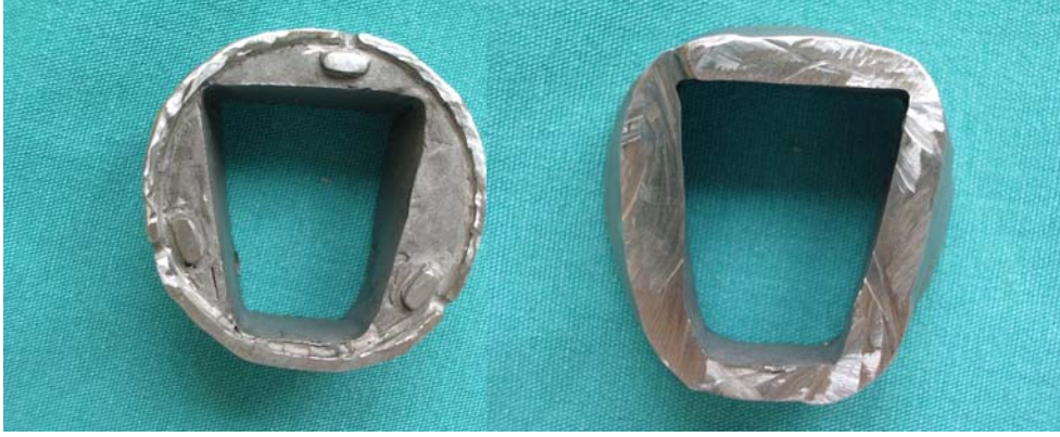
Resim 5. A) Spektrofotometrenin başlığına oturacak şekilde hazırlanmış metal kalıbın alttan görünüşü B) Spektrofotometrenin başlığına oturacak şekilde hazırlanmış metal kalıbın üstten görünüşü.
