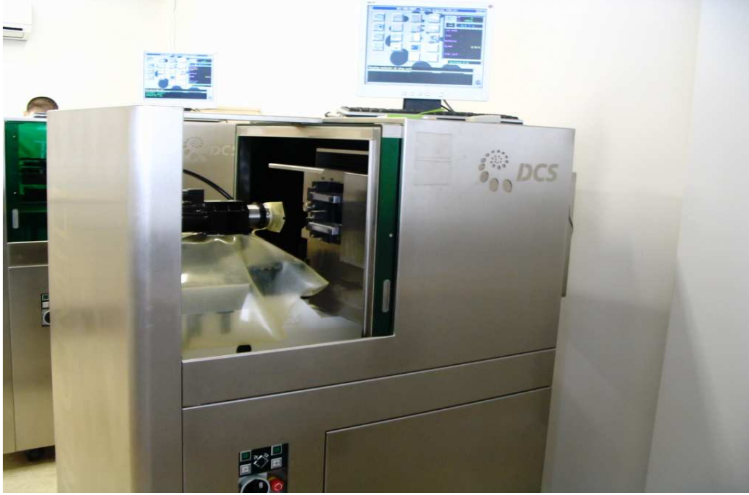
Resim 3.7. DC-Zircon blokların kesimini yapan DCS Precident makinesi
