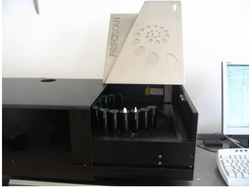
Resim 3.5. Hazırlanan modelin bilgisayarla 3 boyutlu analizini yapan makine.
