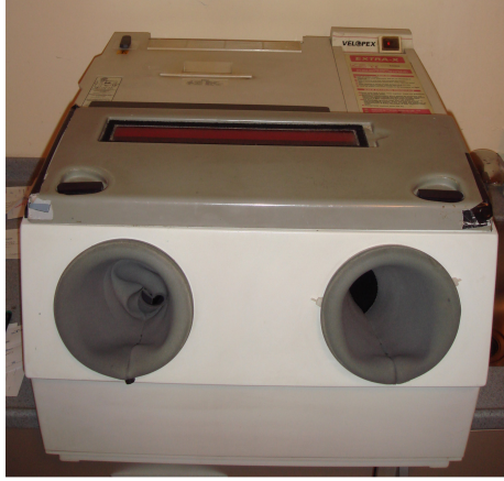
Resim 43. Oklüzal filmlerin banyo edilmesi için kullanılan Velopex Extra-X ( Medivance Instrument Limited, London, UK ) marka otomatik film banyosu
