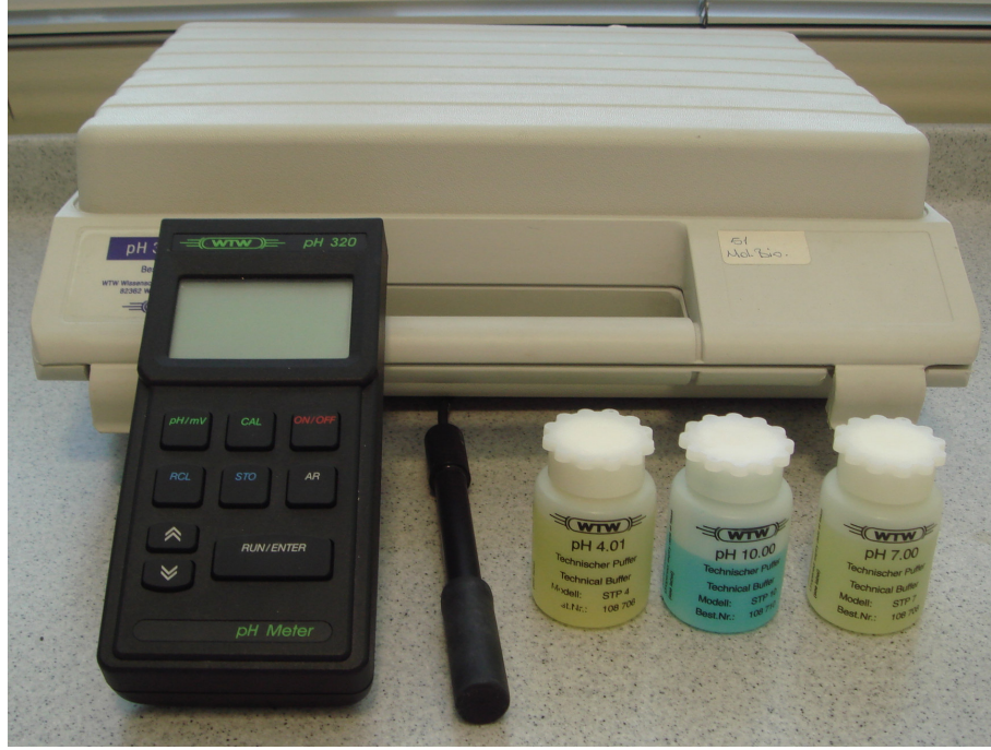
Resim 35. Çalışmada kullanılan pH 320 SET-WTW marka pH metre, SenTix 97 T marka elektrod ucu ve 4.01, 7.00 ve 10.00 olan WTW marka buffer solüsyonları
