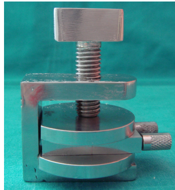
Resim 11. Basma dayanımı testinde siman örneklerinin hazırlanmasında kullanılan paslanmaz çelik kalıp
