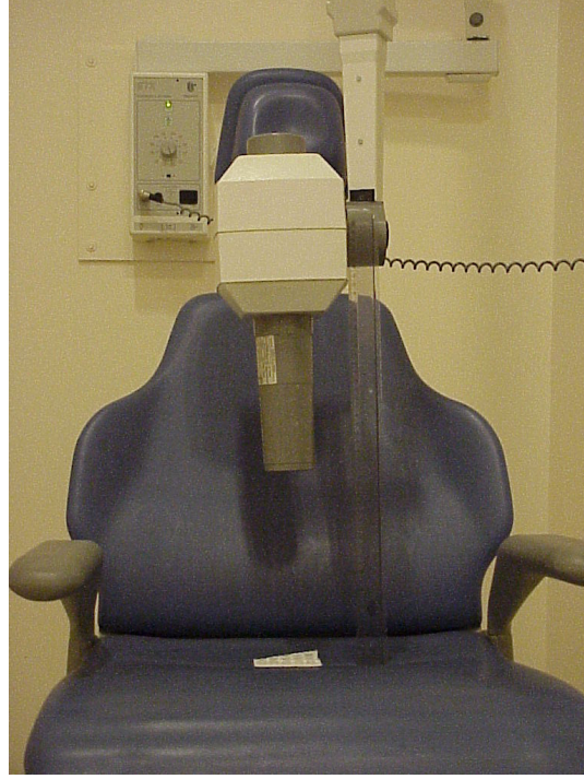
Resim 41. Oklüzal film üzerindeki örneklerin ve step-wedge'in Trophy marka röntgen cihazı ile 40 cm film-ışın kaynağı mesafesinden radyografisinin alınması
