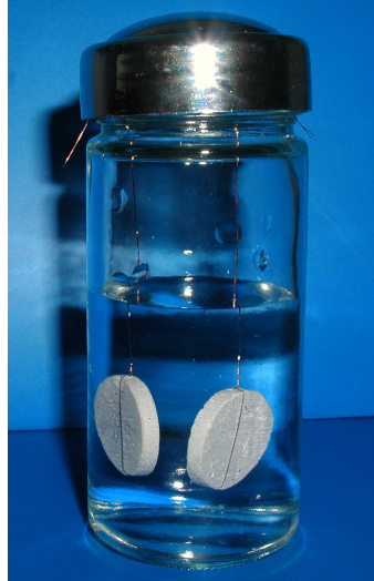
Resim 21. Çözünürlük testi için hazırlanan örneklerin distile su içerisine yerleştirilmesi
