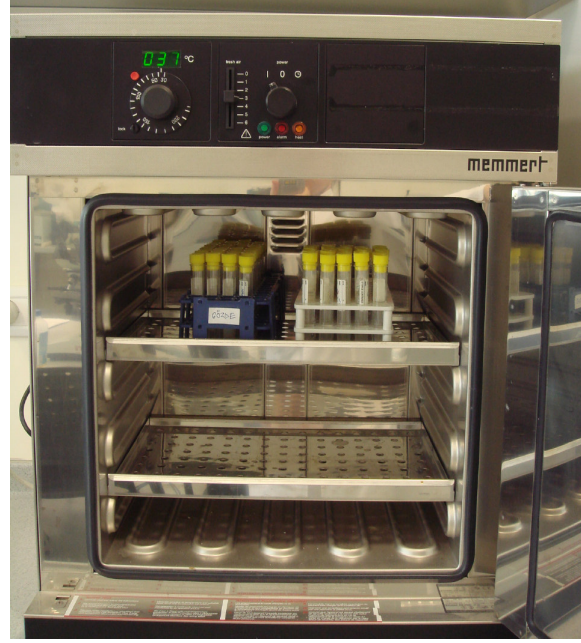
Resim 27. Örneklerin deney süresince saklandığı (37\pm 1) ^\circ\text{C} 'lik etüv
