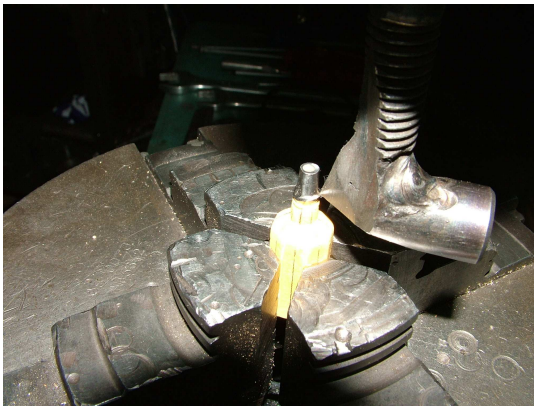
Resim 3.70. Ölçüm modeline çentik atılması
