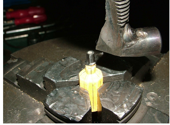
Resim 3.69. CNC makinasına sabitlenmiş ölçüm modeli
