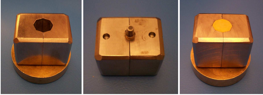
Resim 3.2. Sekizgen kalıp içindeki alçı model
