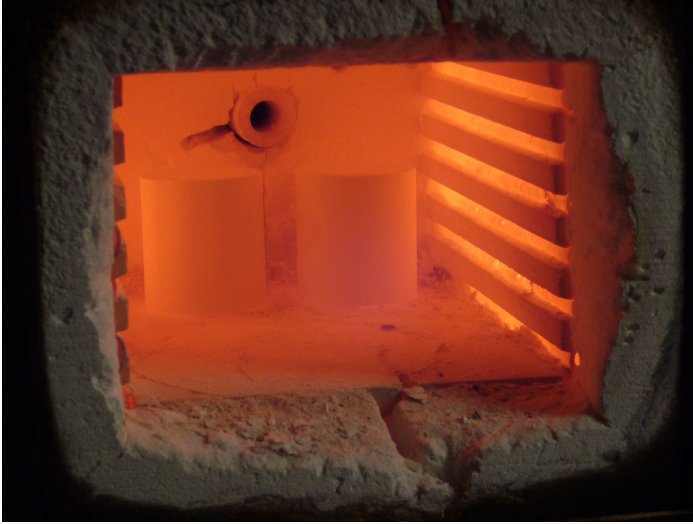
Resim 3.21. Ön ısıtma fırını
