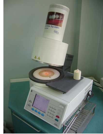
Resim 3.22. Ivoclar EP600 Pres Fırını
