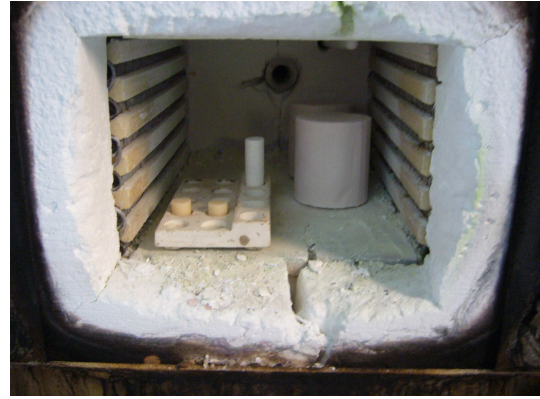
Resim 3.42. Ön ısıtma fırını
