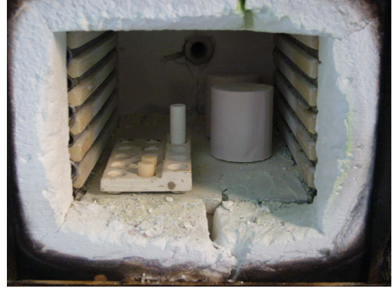
Resim 3.58. Ön ısıtma fırını
