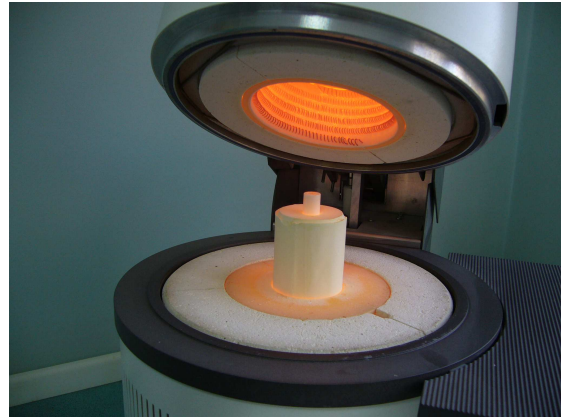
Resim 3.24. Üzerine alüminyum-oksit itici piston yerleştirilmiş preslenmeye hazır manşet
