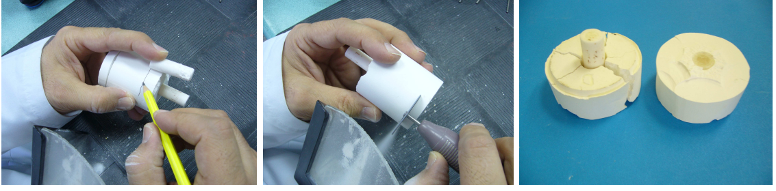
Resim 3.26. Piston boyunun işaretlenerek fazla manşetin kesilmesi
